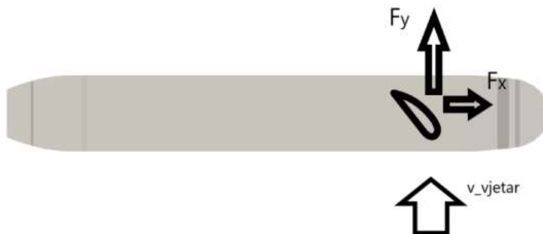
Slika 2. Reakcijske aerodinamičke sile jedra uslijed strujanja bočnog vjetra.
