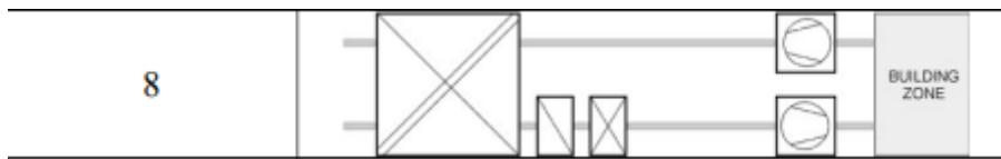
Slika 14. Varijanta klimatizacijskog sustava s rekuperatorom, grijачем i hladnjakom
