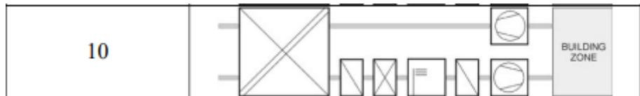
Slika 17. Varijanta klimatizacijskog sustava s rekuperatorom, grijачem, hladnjakom, parnim ovlaživačem i dogrijачem (shema 10)
