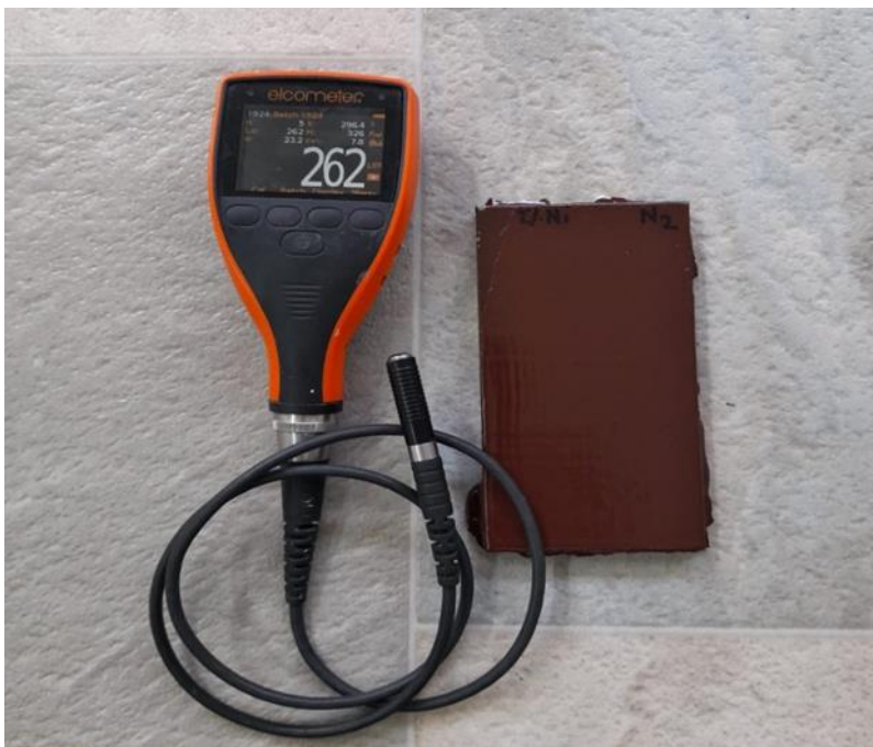
Slika 17. Uređaj za mjerenje debljine epoksidnog premaza-Elcometer 456.
