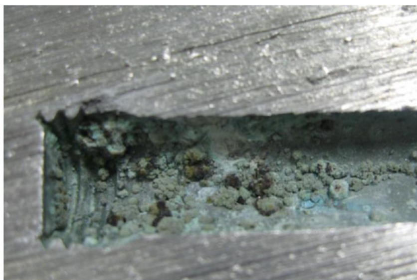
Slika 9. Primjer gdje bakterije SRB napadaju kanale aluminijske rashladne ploče [21].
