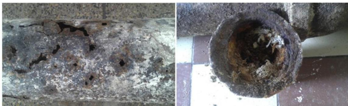
Slika 8. Primjeri učinaka korozije/biokorozije u cjevovodima [22].
