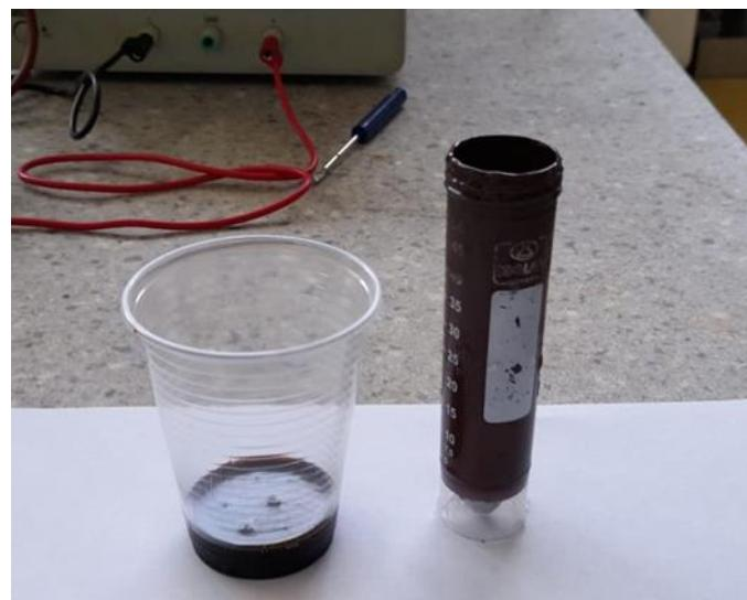
Slika 15. Epoksidni premaz sa česticama nikla i učvršćivač.
