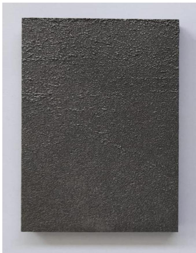
Slika 13. Uzorak sivog lijeva.
