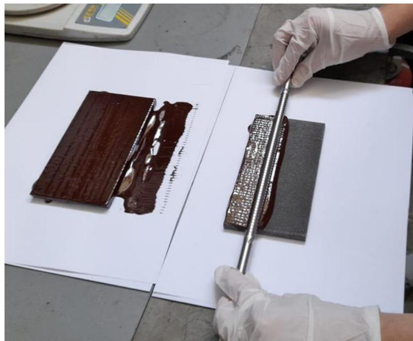
Slika 16. Postupak nanošenja premaza pomoću aplikatora.
