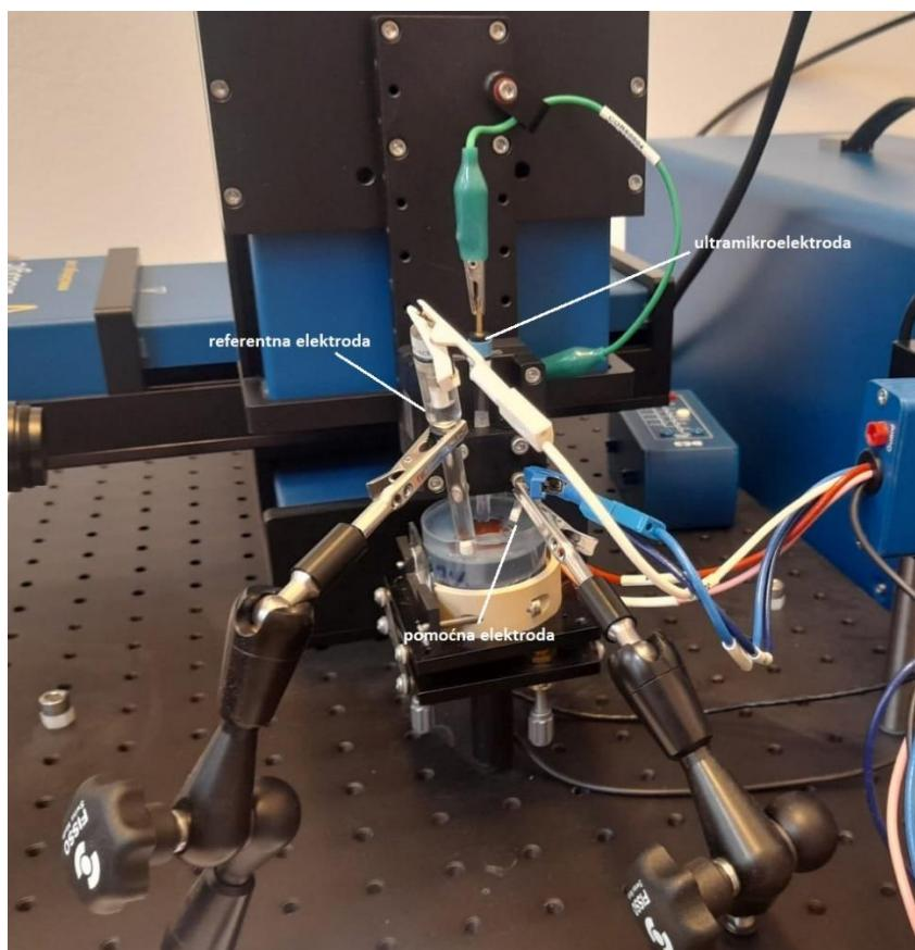
**Slika 25. Prikaz elektrokemijske čelije za ispitivanje topografije uzorka pomoću ic-ac SECM metode.**
