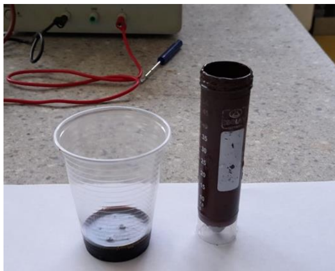
Slika 15. Epoksidni premaz sa česticama nikla i učvršćivač.
