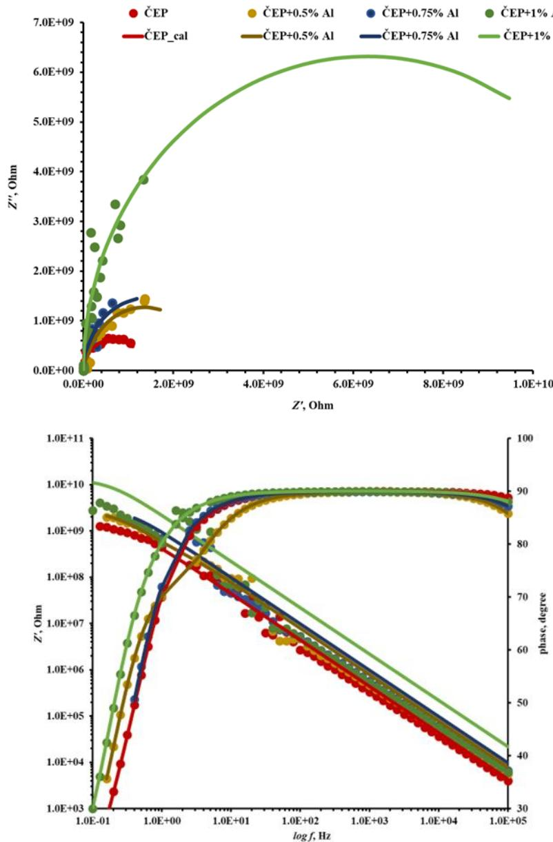
**Slika 21. Prikaz (a) Nyquistovog i (b) Bodeovog dijagrama za čistu epoksidnu prevlaku, te za epoksidnu prevlaku koja sadrži 0,5%, 0,75% i 1% nanočestica aluminija nakon 24 sati izloženosti u 3,5% otopini NaCl-a.**
