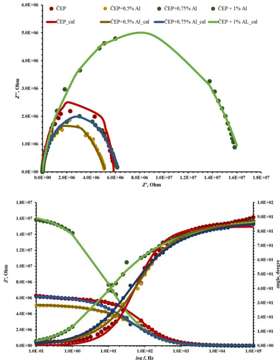
**Slika 22. Prikaz (a) Nyquistovog i (b) Bodeovog dijagrama za čistu epoksidnu prevlaku, te za epoksidnu prevlaku koja sadrži 0,5%, 0,75% i 1% nanočestica aluminija nakon 7 dana izloženosti u 3,5% otopini NaCl-a.**
