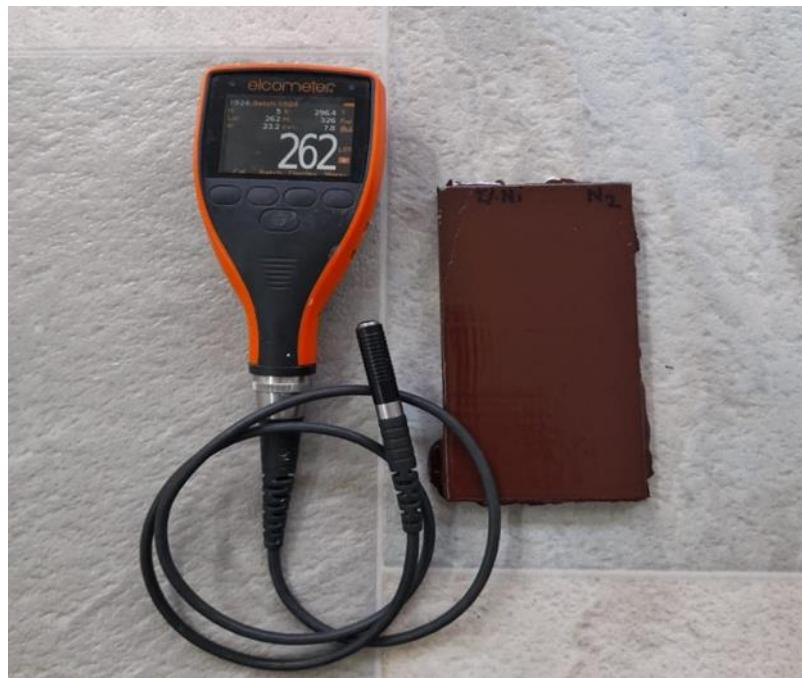
**Slika 17. Uredaj za mjerjenje debljine epoksidnog premaza-Elcometer 456.**
