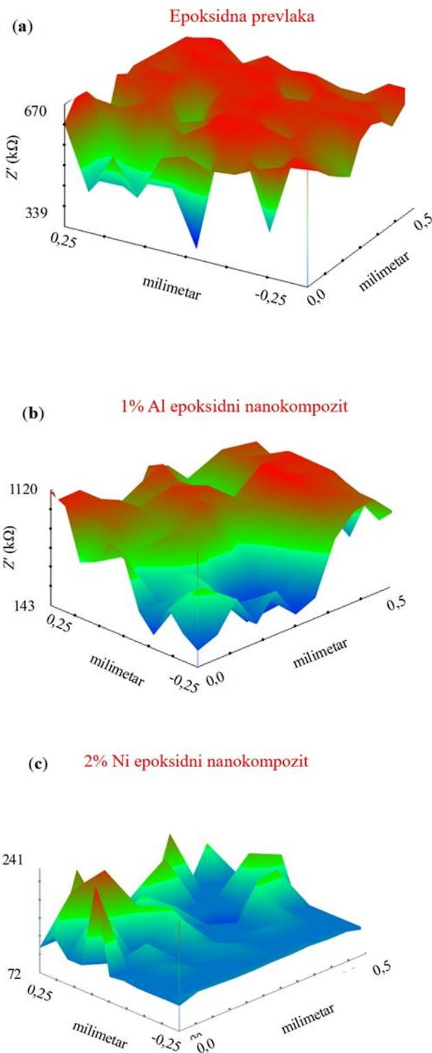
**Slika 26.** Prikaz distribucije impedancijskih vrijednosti za uzorke (a) čista epoksidna prevlaka, (b) epoksidna prevlaka s 1% Al NČ i (c) epoksidna prevlaka s 2% Ni NČ dobiveni mjerjenjem u vodovodnoj vodi pomoći ic-ac SECM metode.
