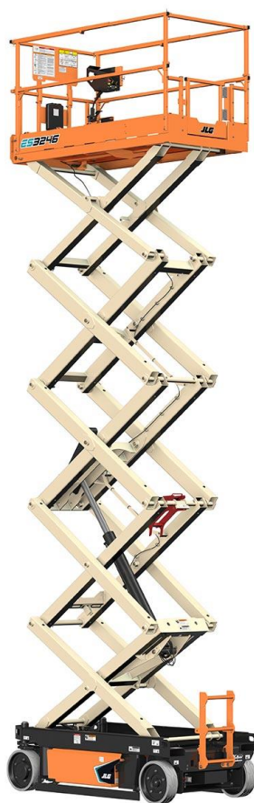
Slika 4. Škarasta podizna platforma ES1932 [5]
