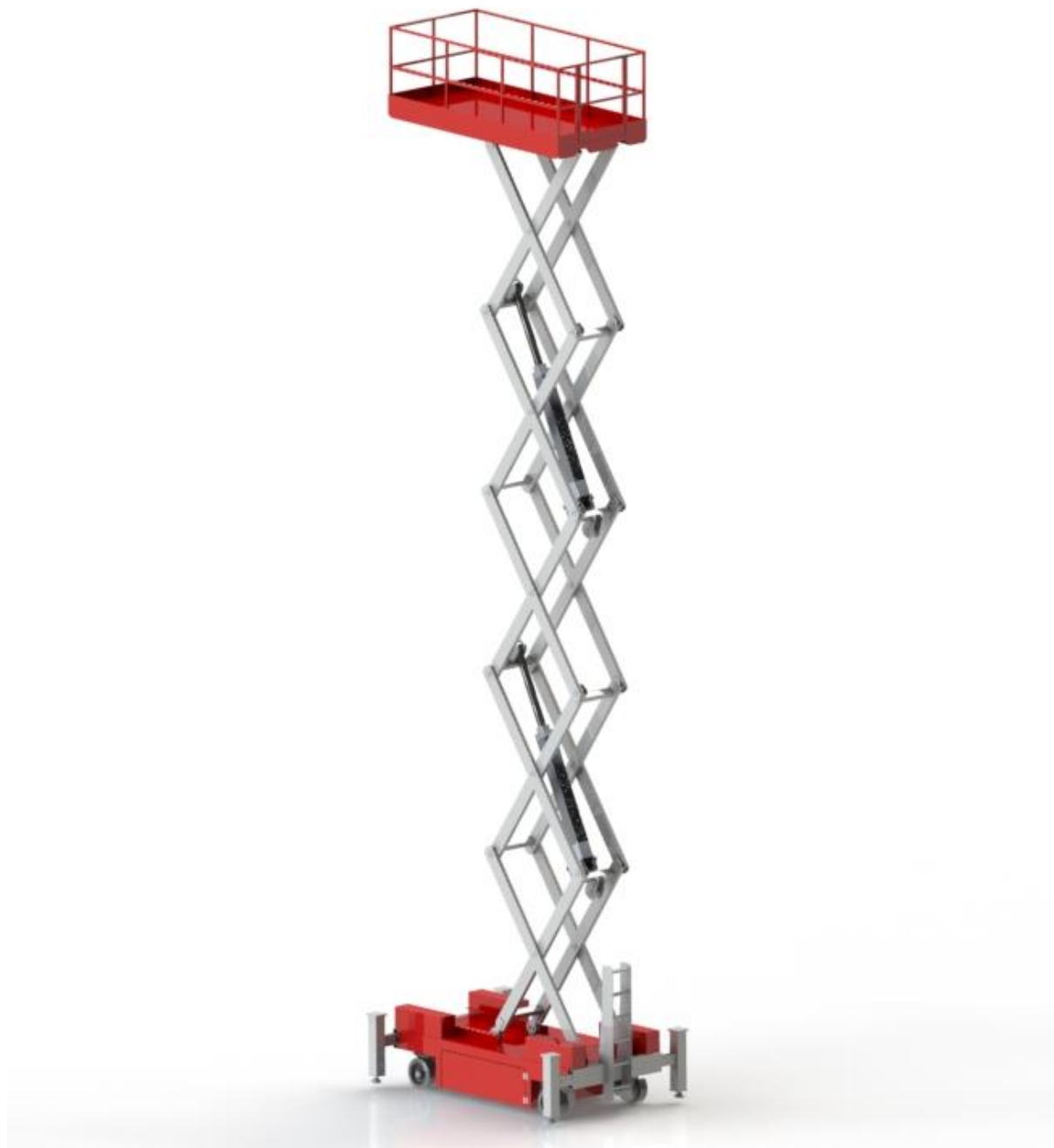
Slika 83. Prikaz podignute škaraste platforme
