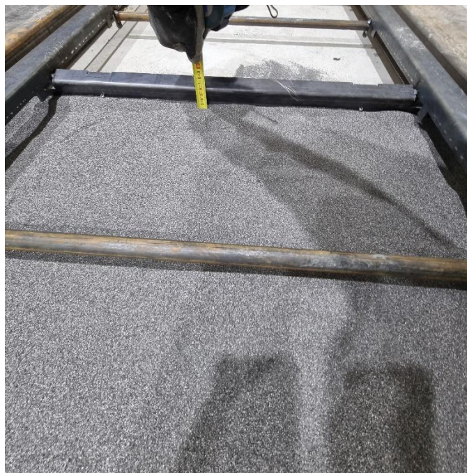
Slika 40 Mjerenje visine sačme
