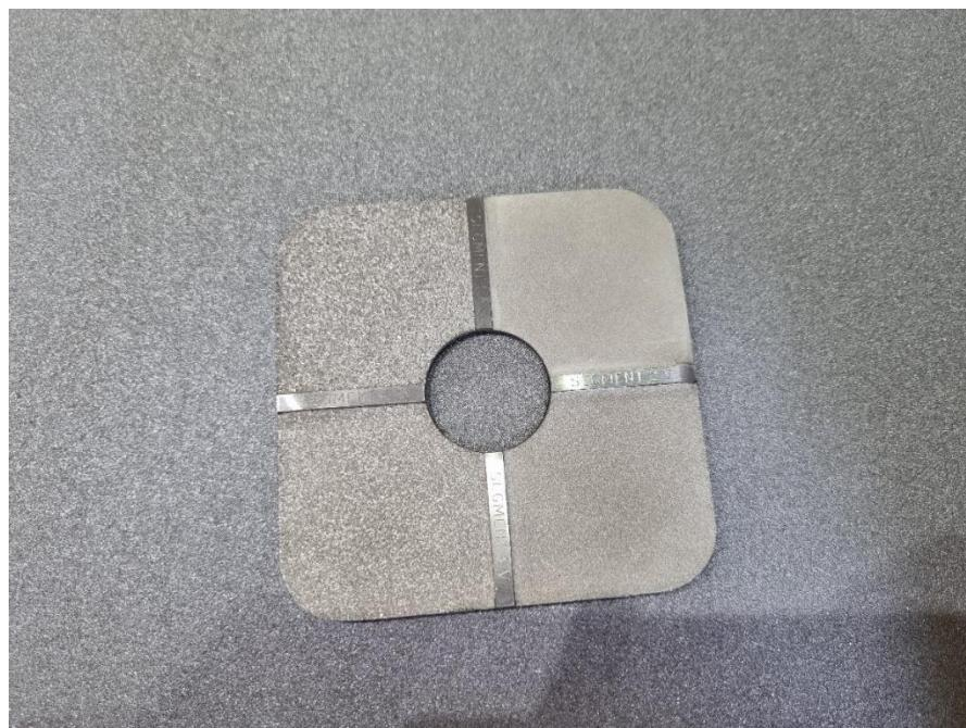
**Slika 18 Ispitna pločica za procjenu kvalitete čišćenja sačmom**
