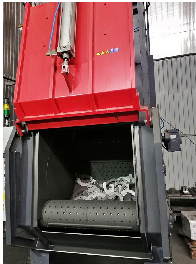
Slika 13 Bubnjasti stroj za sačmarenje tvrtke Gostol TST d.d. [4]
