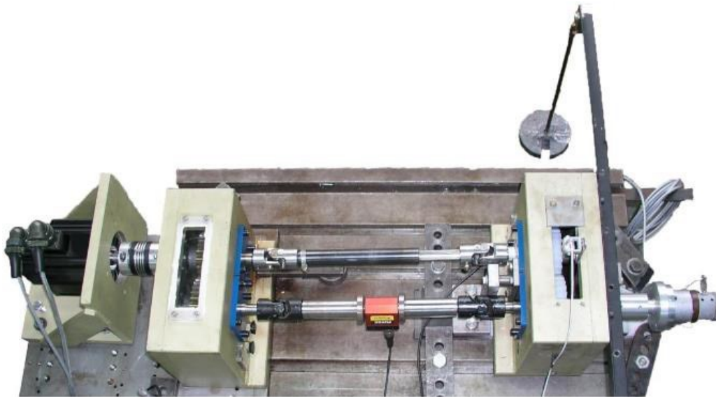
Slika 32. Stvarna izvedba uređaja za ispitivanje zupčanika (FSB)
