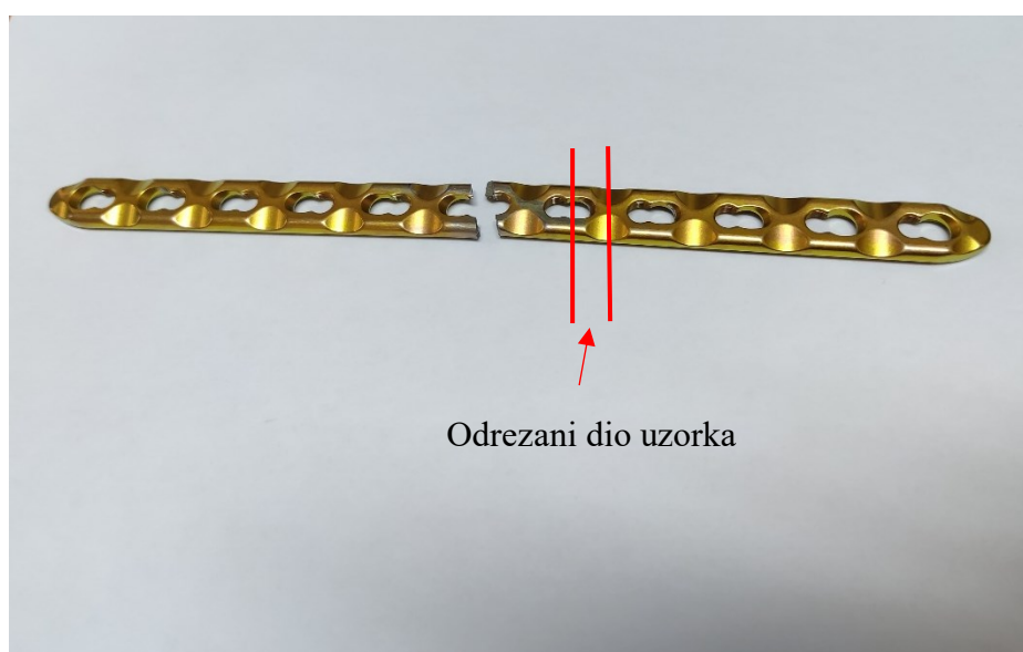
Slika 32. Titanijeva pločica i mjesto izrezivanja za analizu mikrostrukture
