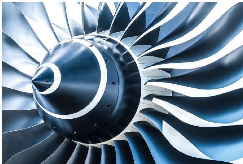
Slika 4. Lopatica turbine zrakoplovnog motora izrađena od alfa titanij legure [10]
