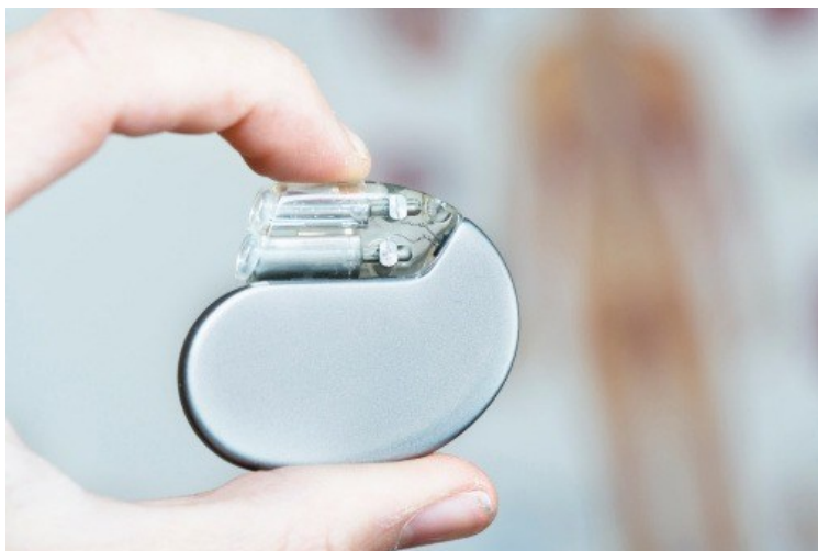
Slika 9. Uređaj za upravljanje srčanim ritmom napravljen od platine [22]
