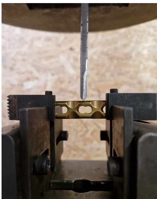
Slika 43. Uzorak pločice prije ispitivanja savojne čvrstoće
