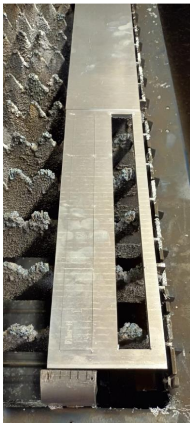
Slika 27. Položaj priprema lima s izrezanim uzorkom na radnom stolu lasera
