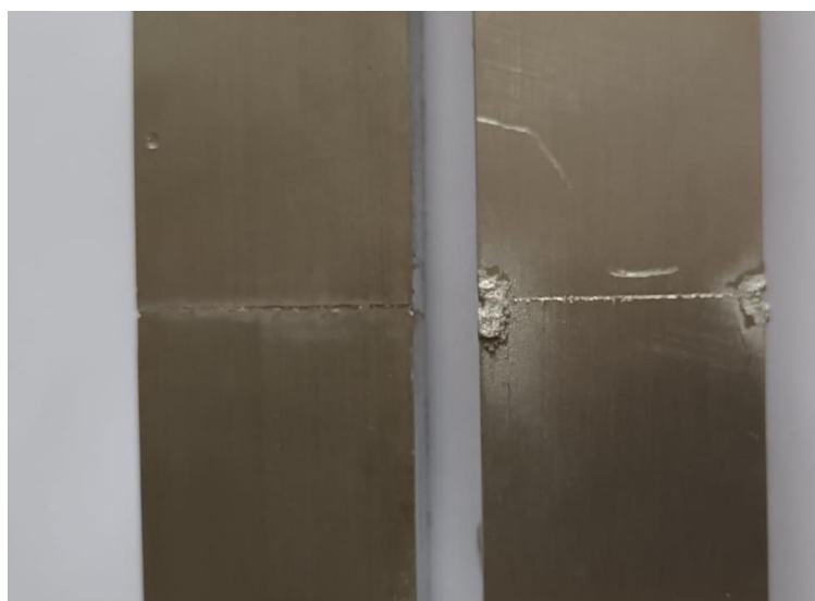
Slika 36. Tragovi proboja na gornjoj površini materijala debljine 8 mm (lijevo – fiber laser, desno – CO 2 laser)
