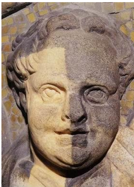
Slika 1. Primjer laserskog čišćenja kamena [2]
