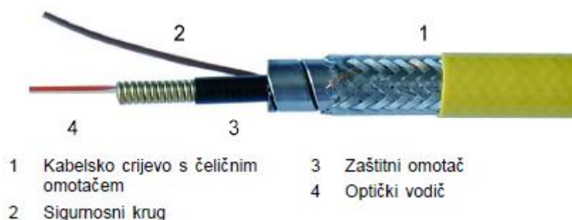
Slika 19. Optički kabel fiber lasera [13]
