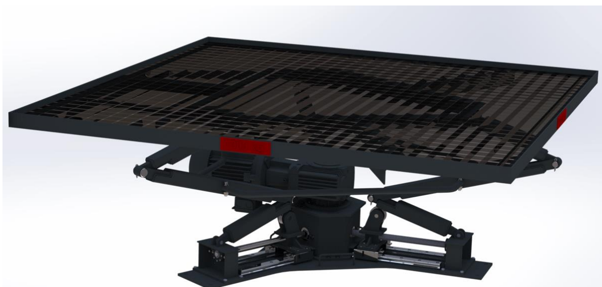
Slika 53. Podizna platforma donji položaj – 3D render
