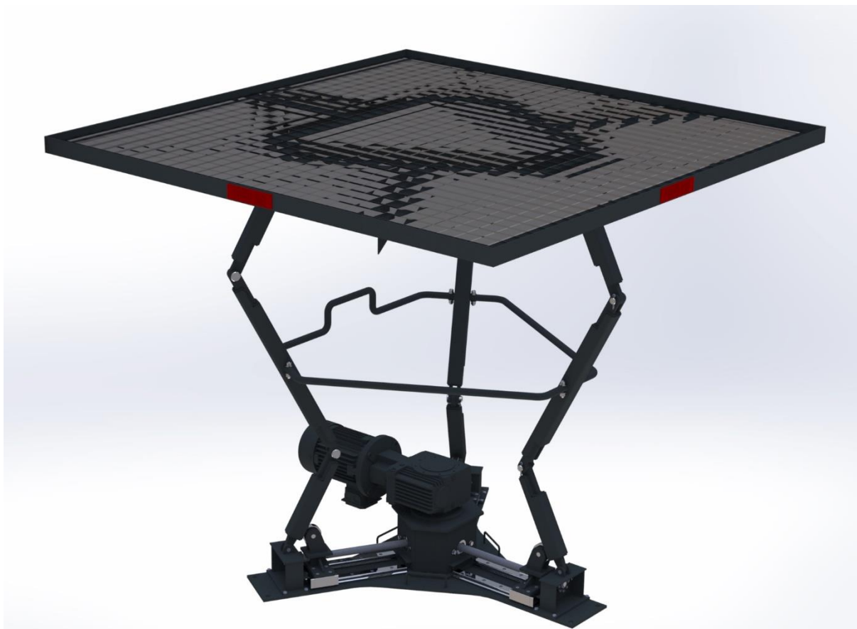
Slika 52. Podizna platforma gornji položaj – 3D render
