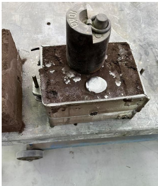
Slika 55 Hlađenje i skrućivanje odljevka
