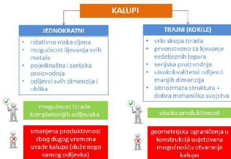
Slika 5 Značajke jednokratnih i trajnih kalupa [4]
