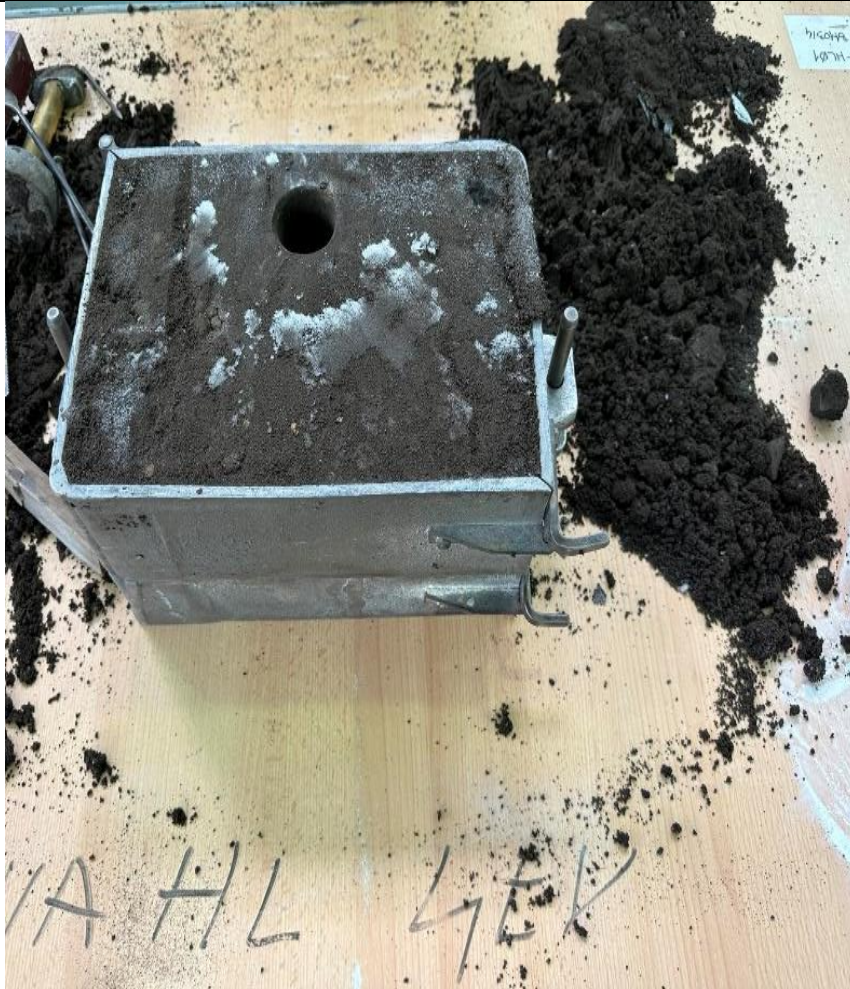
Slika 52 Izrađen kalup spreman za lijevanje
