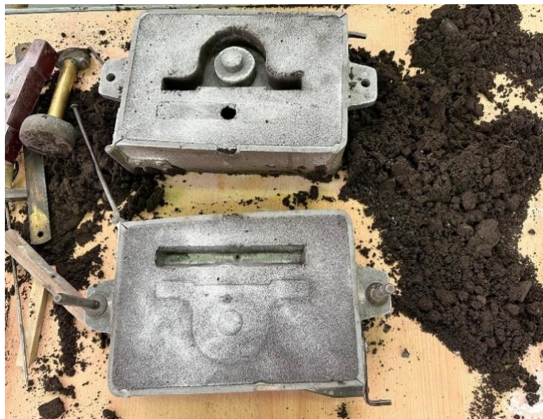
Slika 51 Donjak i gornjak prije zatvaranja kalupa
