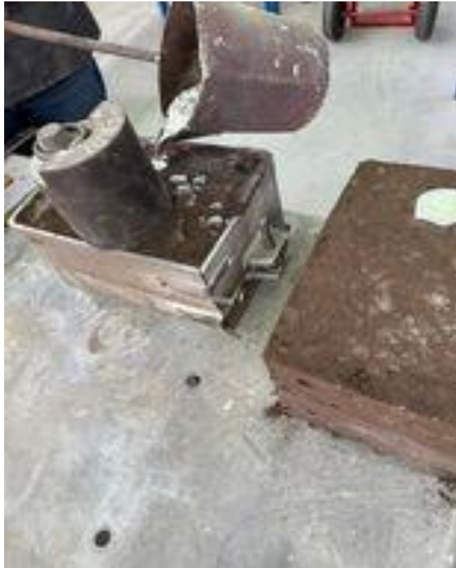
Slika 54 Lijevanje taljevine u kalup
