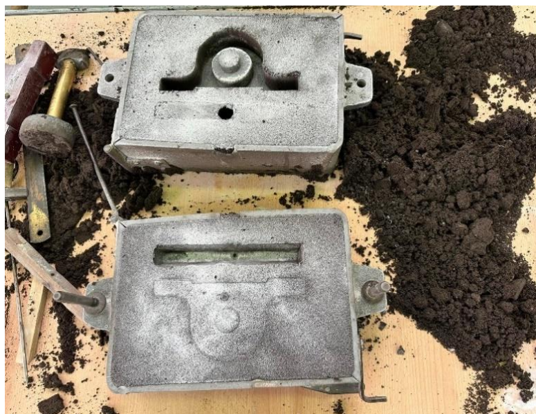
Slika 51 Donjak i gornjak prije zatvaranja kalupa
