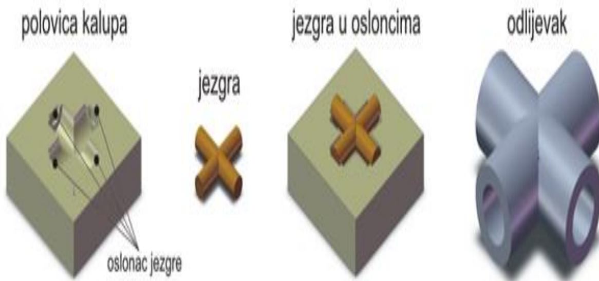
Slika 10 Jezgra, kalup i odljevak [8]
