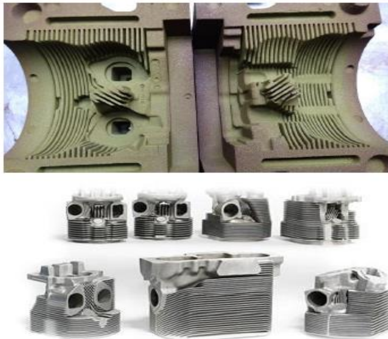
Slika 7 Pješčani kalup i odljevak cilindra za zrakoplove [6]
