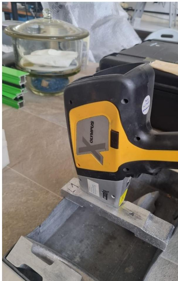
Slika 59 Određivanje kemijskog sastava odljevka XRF metodom
