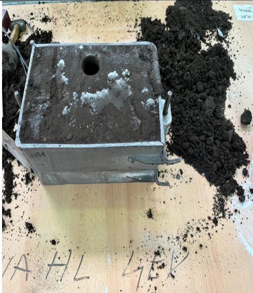
**Slika 52 Izrađen kalup spreman za lijevanje**
