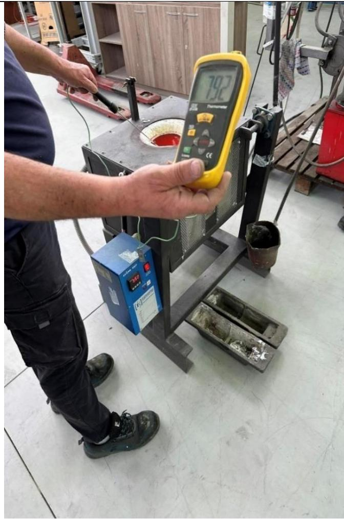
**Slika 53 Temperatura taljevine u elektrootpornoj peći**
