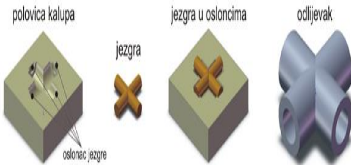
Slika 10 Jezgra, kalup i odljevak [8]
