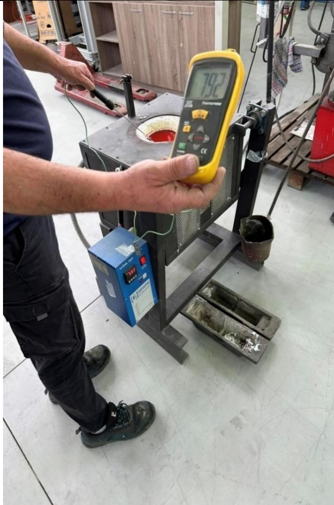
Slika 53 Temperatura taljevine u elektrootpornoj peći
