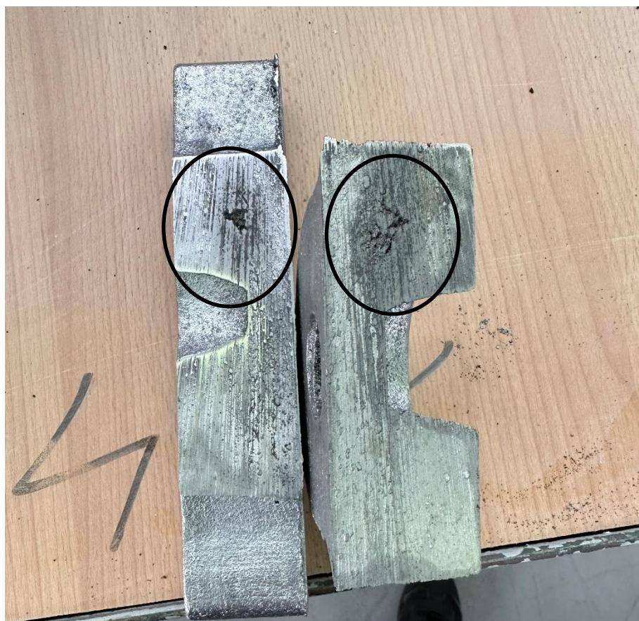
Slika 58 Prikaz poroznosti na odljevku
