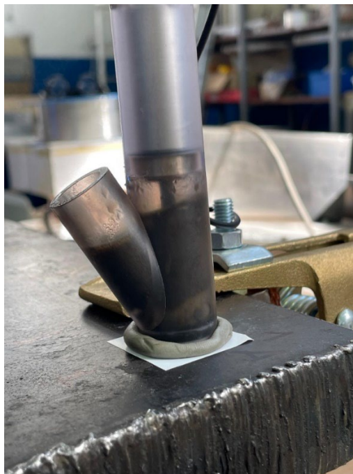
Slika 38. Elektropoliranje uzorka kutnog spoja
