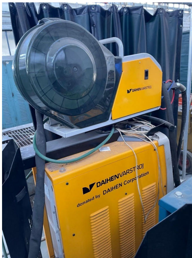
Slika 27. Izvor struje za zavarivanje Daihen Varstroj WB-P500L s dodavačem žice
