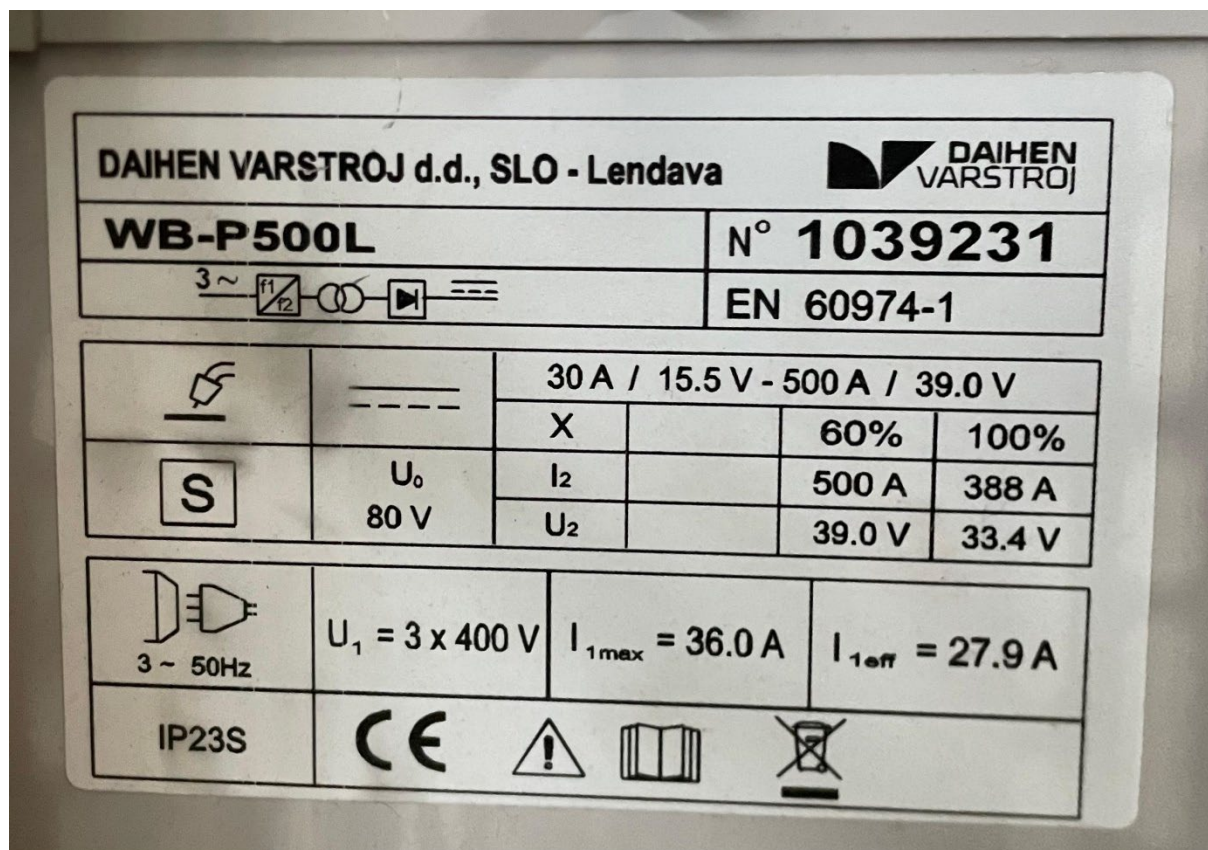
Slika 28. Identifikacijska pločica izvora za zavarivanje Daihen Varstroj WB-500L
