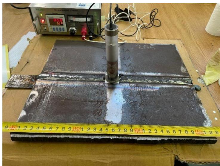
Slika 57. Elektropoliranje nadvišenja zavara
