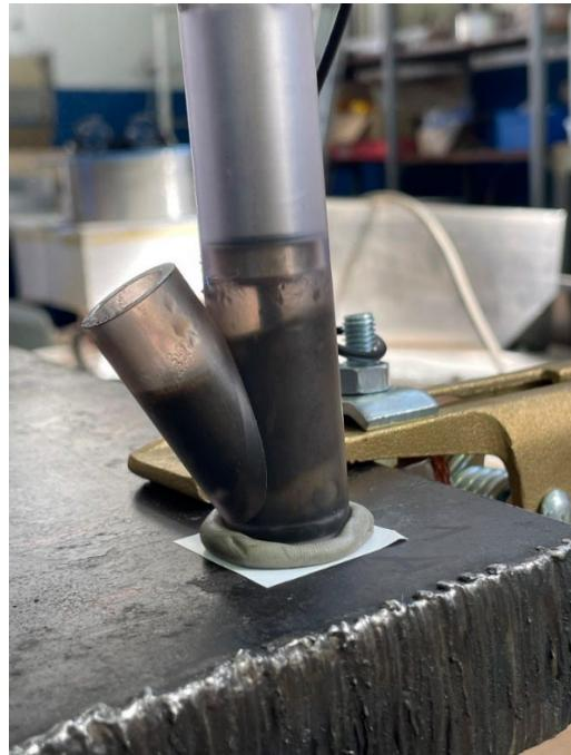
Slika 38. Elektropoliranje uzorka kutnog spoja
