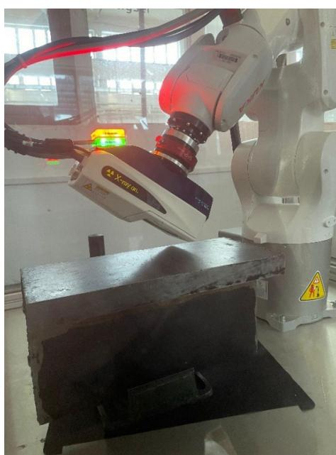
**Slika 33. Mjerenje zaostalih naprezanja na uzorku kutnog spoja**
