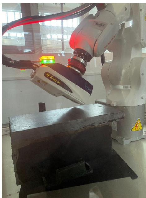
Slika 33. Mjerenje zaostalih naprezanja na uzorku kutnog spoja
