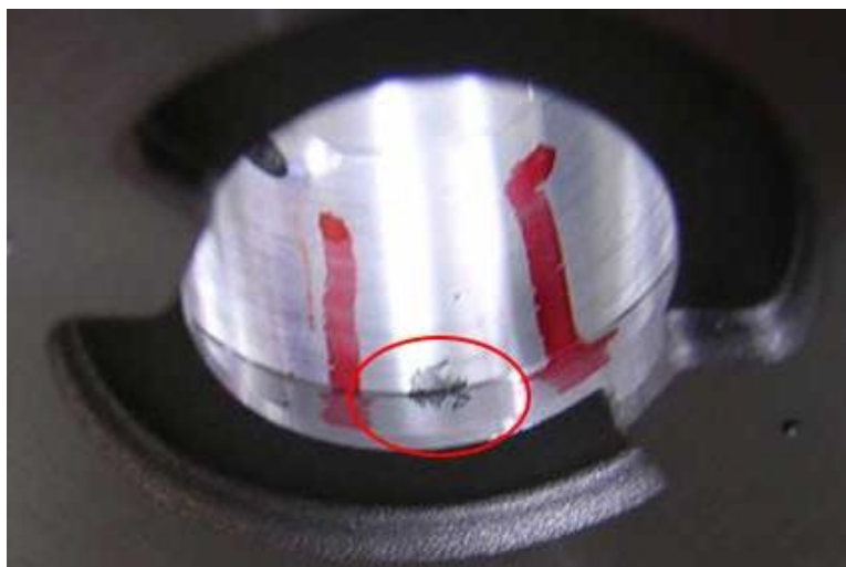
Slika 21. Primjer uključka na površini odljevka [12]
