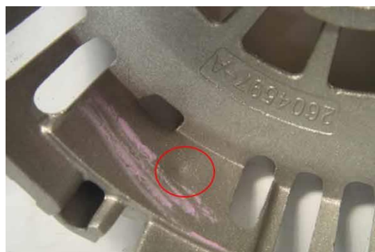
Slika 28. Primjer udubine na površini odljevka [9]
