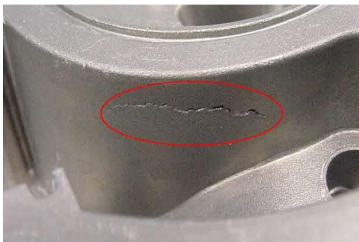
Slika 20. Primjer pukotine na odljevku [9]
