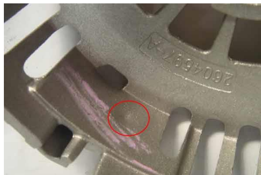
Slika 28. Primjer udubine na površini odljevka [9]
