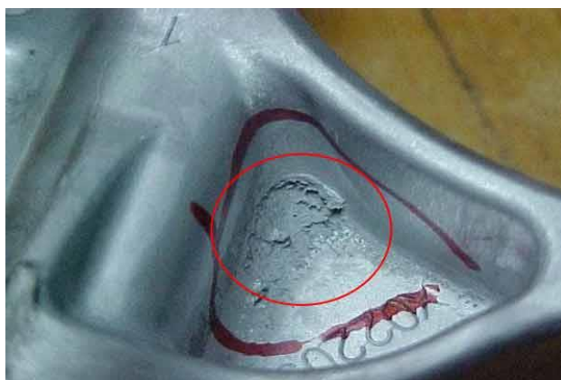
Slika 24. Greška naljepka na kalupu očitana kao udubina na rezultirajućem odljevku[9]
