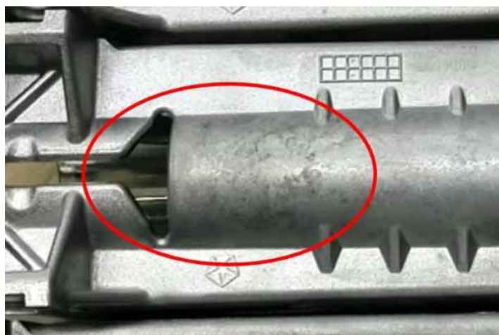
Slika 25. Primjer tragova protoka na odljevku [9]
