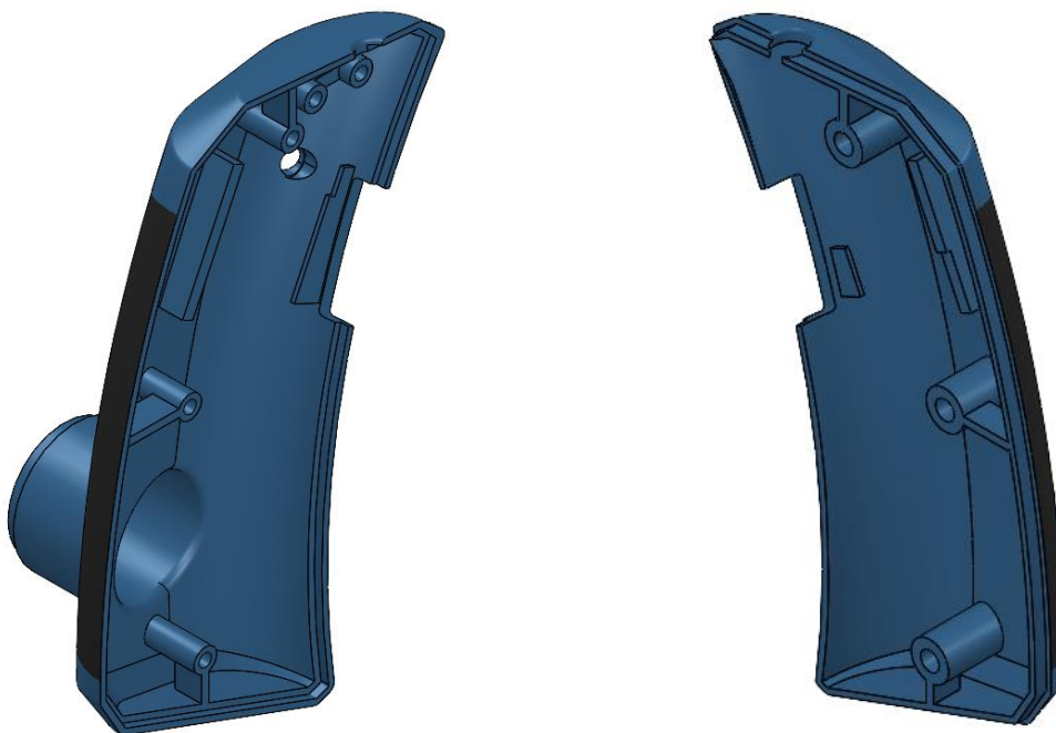
Slika 69. a) Lijeva polovica desne ručke; b) Desna polovica desne ručke
