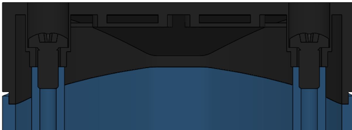
Slika 65. Vijčani spoj poklopca i gornjeg kućišta motorvretena
