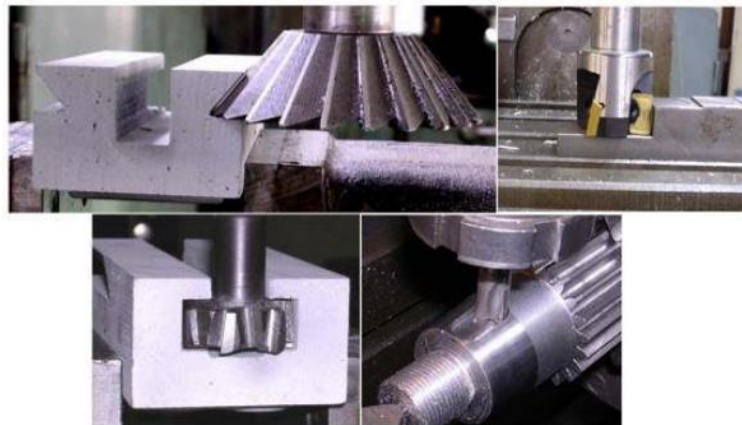
Slika 17. Postupci glodanja vertikalnom glodalicom
