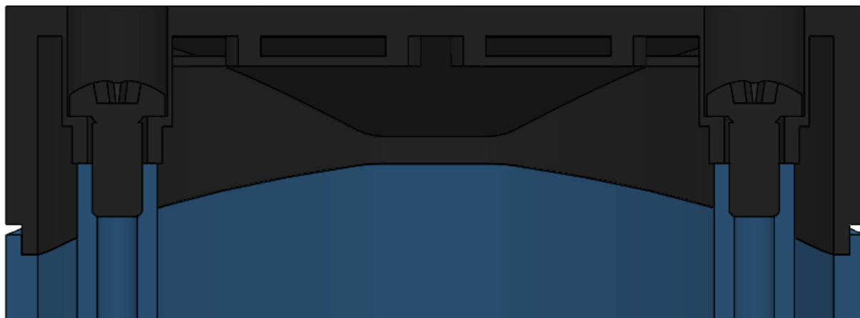
Slika 65. Vijčani spoj poklopca i gornjeg kućišta motorvretena
