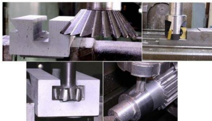
Slika 17. Postupci glodanja vertikalnom glodalicom
