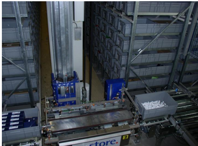
Slika 42. Utovar/istovar spremnika s dizalice na konvejjere
