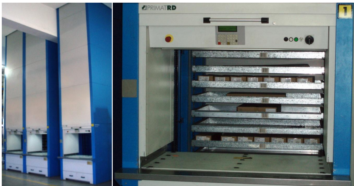
Slika 30. VLM-Vertikalni podizni moduli
