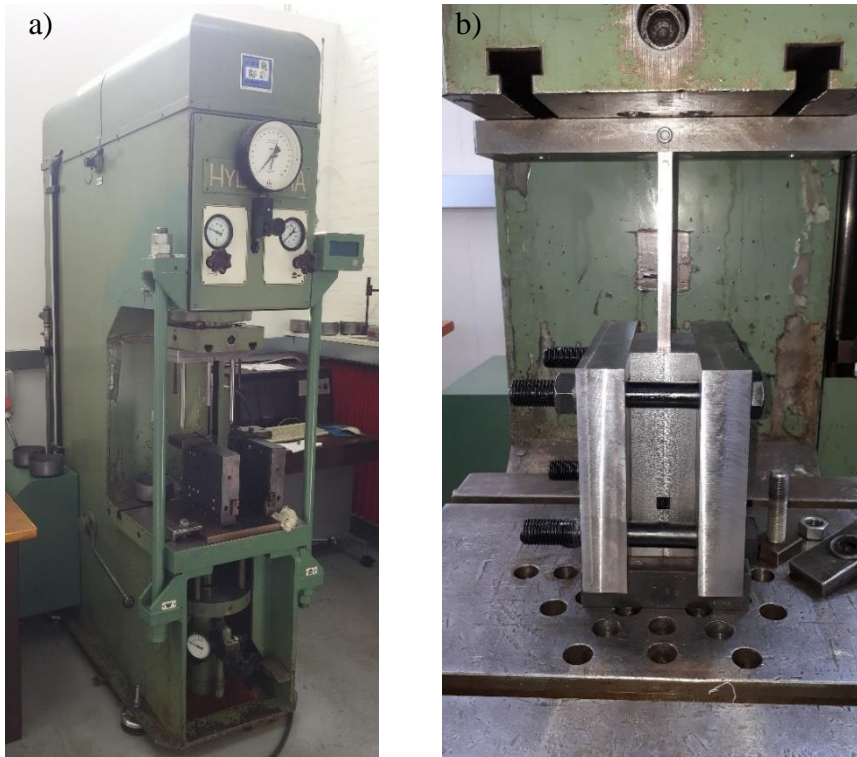
Slika 5.7 Oprema za kutno istiskivanje: a) hidraulička preša, b) alat na preši
