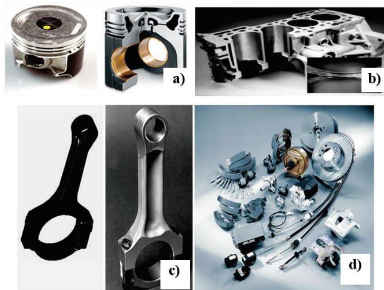
Slika 2.6 Proizvodi MMC na aluminijskoj osnovi u automobilske industriji: a) klip, b) dio motora, c) klipnjača, d) kočioni sistemi [2,10]
