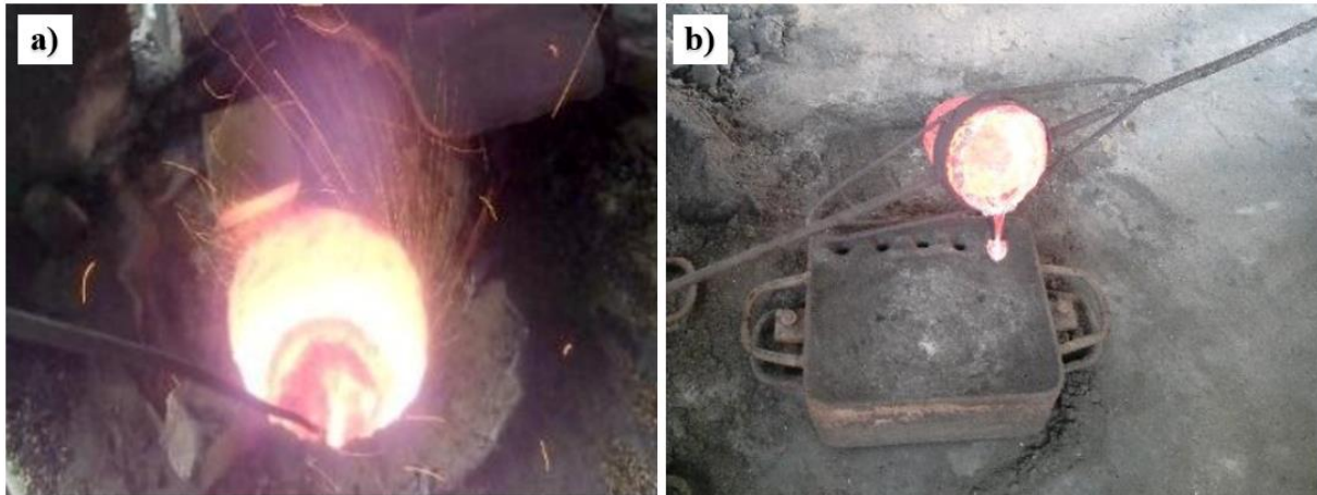
Slika 2.8 a) Miješanje lebdećeg pepela u aluminijskoj matrici, b) lijevanje taline u kalup [18]
