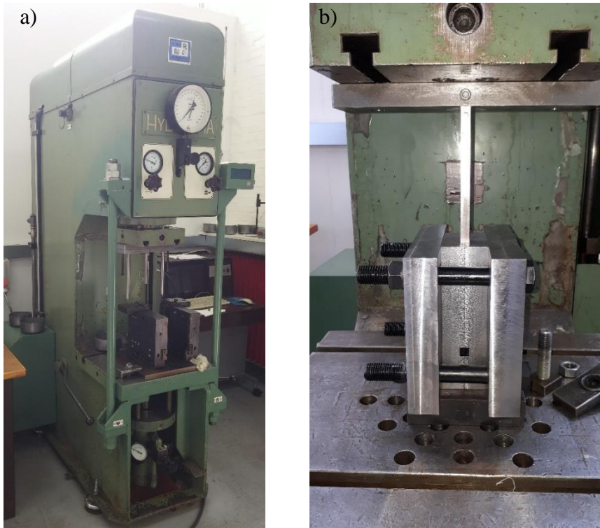
Slika 5.7 Oprema za kutno istiskivanje: a) hidraulička preša, b) alat na preši
