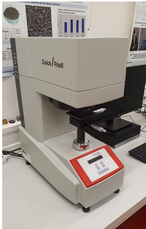
Slika 5.15 Tvrdomjer ZHV \mu -ST (Zwick/Roell/Indentec)
