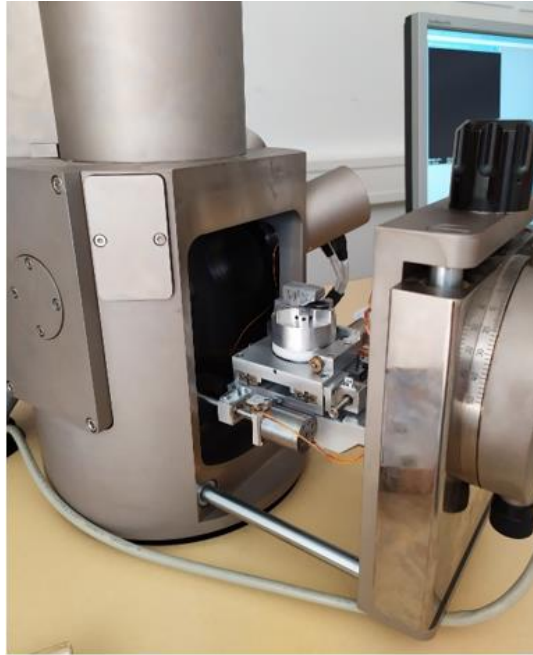
Slika 5.13 Pretražni elektronski mikroskop SEM Tescan Vega TS5136MM
