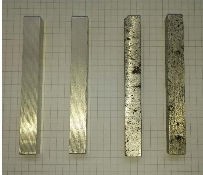
Slika 5.9 Uzorci kompozita pripremljeni za kutno istiskivanje
