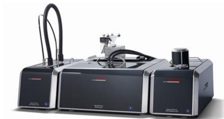
Slika 5.3 Uređaj za određivanje raspodjele veličine čestica A22 NanoTech plus
