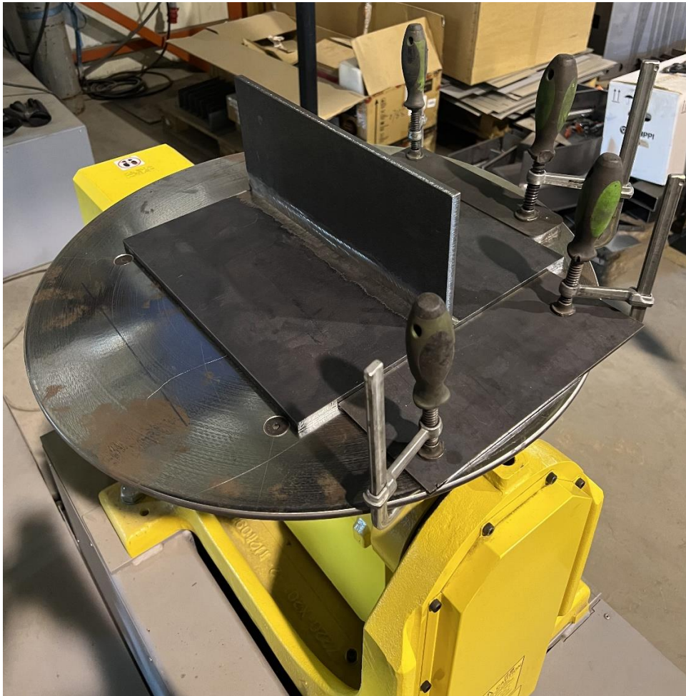
Slika 25. Kutni spoj postavljen na pozicioneru
