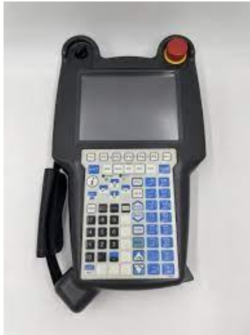
Slika 7. Teach pendant(kontroler) za Fanuc robote
