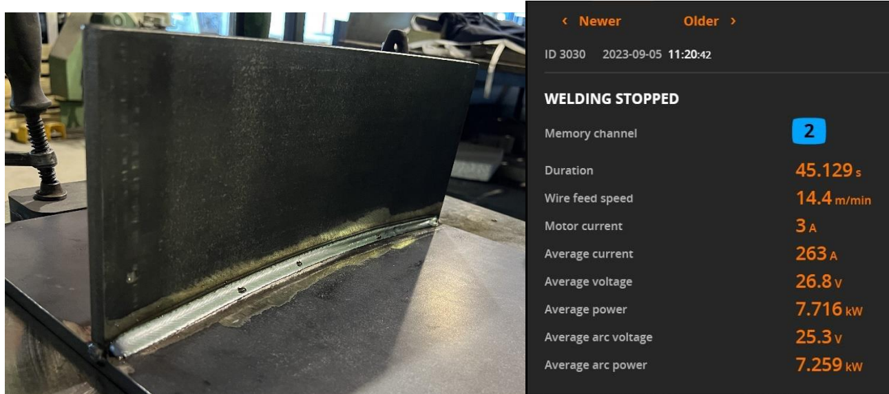
Slika 39. Prikaz trećeg zavora i parametri zavarivanja
