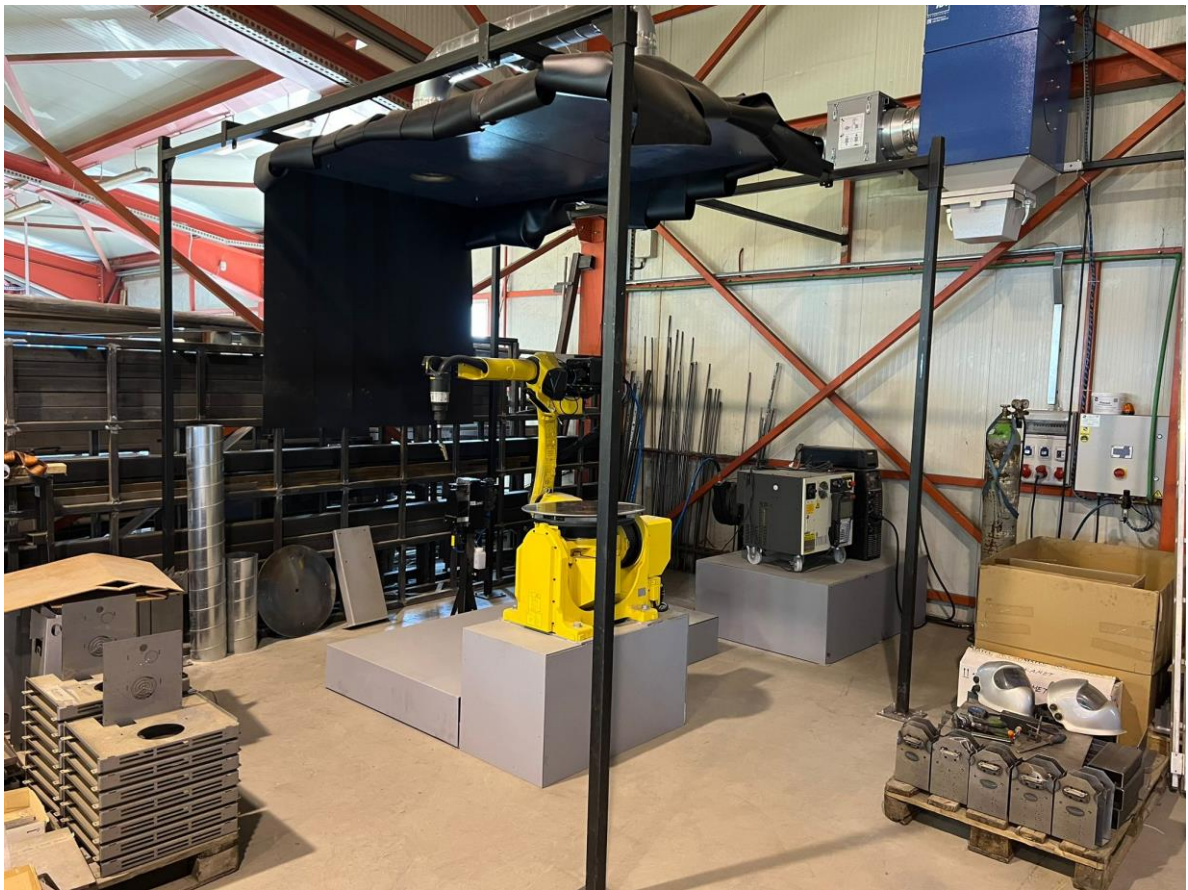
Slika 16. Radni prostor eksperimentalnog rada robotska stanica ARC mate 100iD-10L
