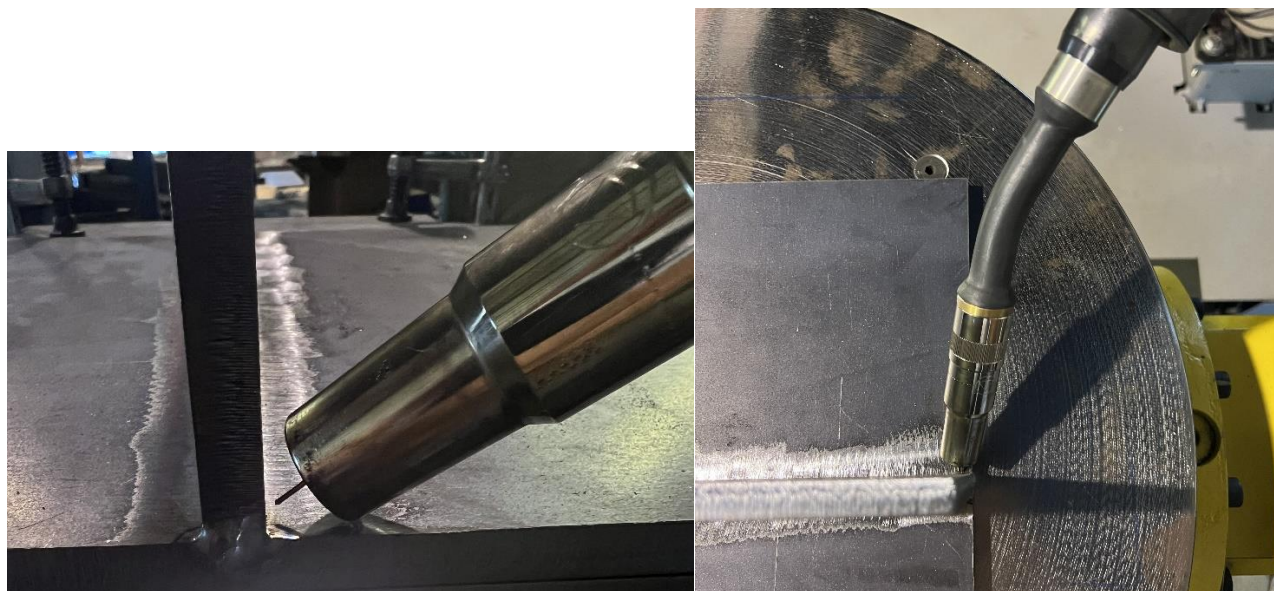
Slika 28. Pozicija vrha žice i pištolja kod zavora
