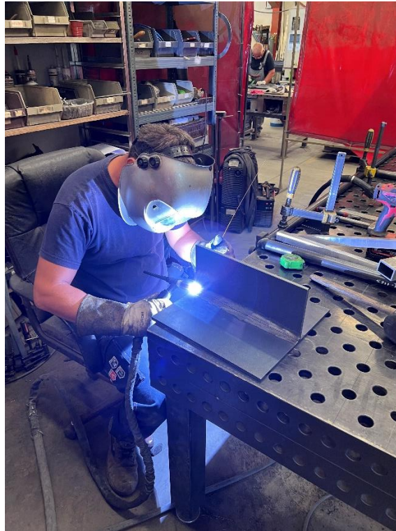
Slika 24. Priprema kutnog spoja i ukrućivanje ploča
