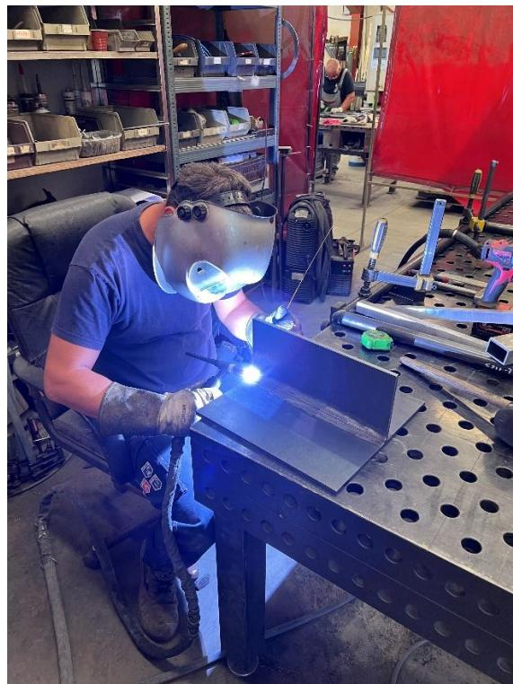
Slika 24. Priprema kutnog spoja i ukrućivanje ploča
