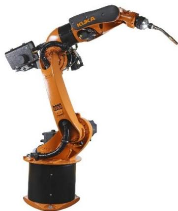
Slika 5. Robot za zavarivanje tvrtke Kuka[20]
