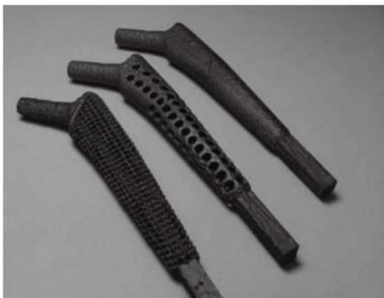
Slika 6. 3D ispisani prototipovi stabla kuka s dizajniranom poroznošću [5]
