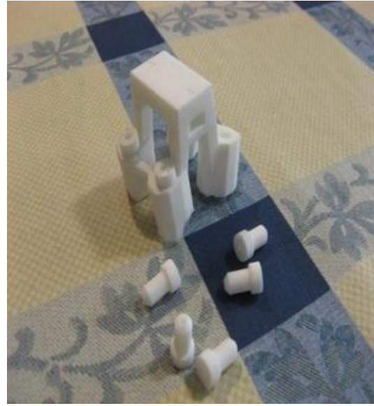
Slika 12. 3D ispisani predložak za vođenje svrdla [11]
