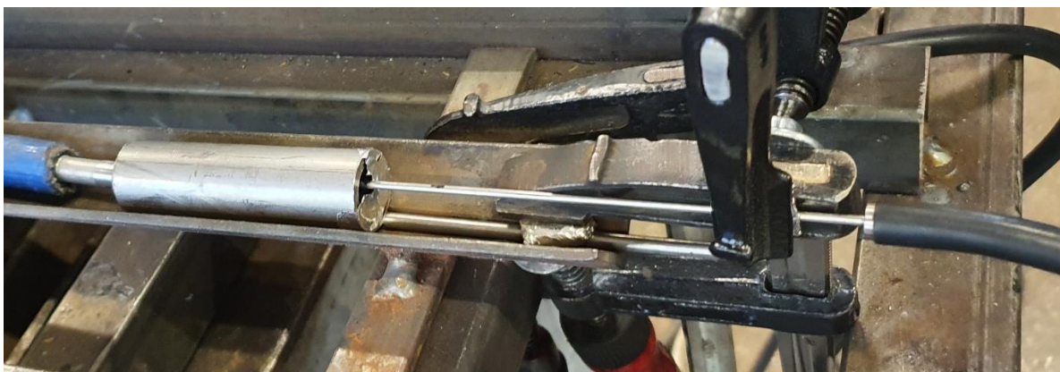
Slika 7. Mjerenje udjela kisika sapnicom oksimetra
