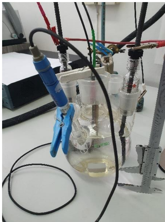
Slika 19. Posuda za test s tri elektrode
