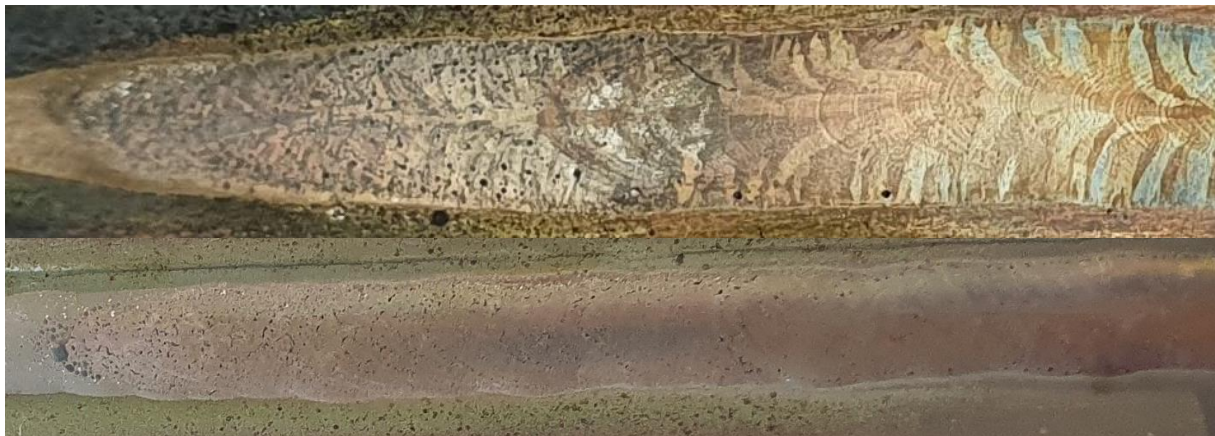
Slika 20. Točkaste formacije oksida
