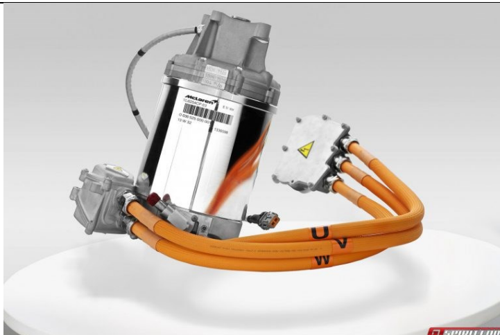
Slika 26. McLaren P1 električni motor (preuzeto iz [22]).
