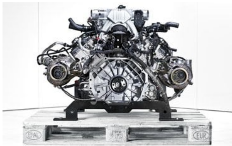
Slika 20. McLaren M838TQ motor (preuzeto iz [22]).
