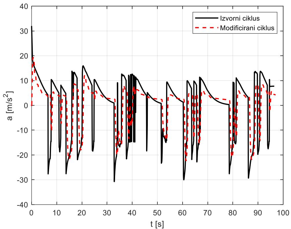
Slika 19. Usporedba akceleracija iz unaprijednog modela vozila.
