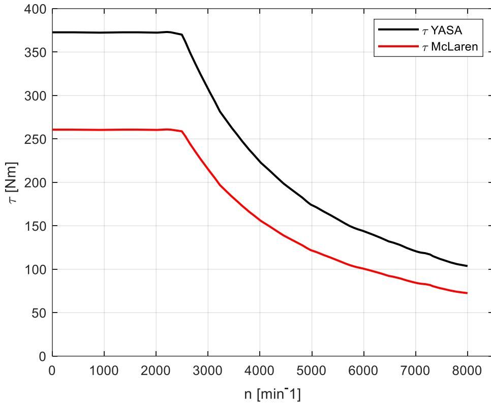
Slika 27. Usporedba krivulje maksimalnih momenata električnih motora.
