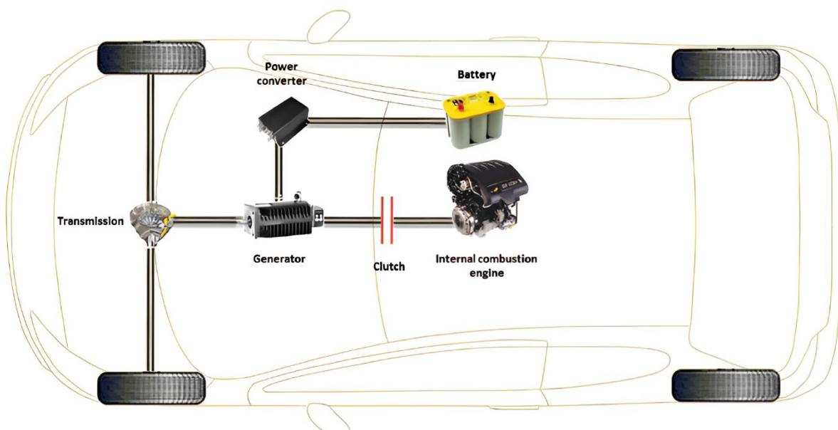
*Slika 4. Paralelna konfiguracija hibridnog pogona (preuzeto iz [1]).*
