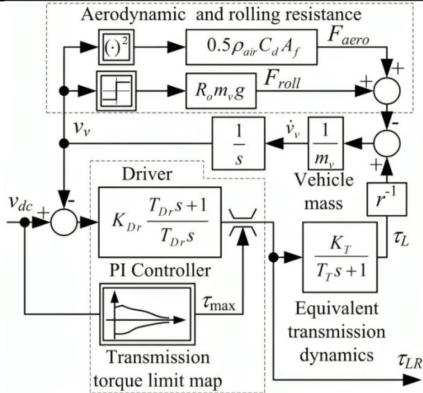
Slika 16. Unaprijedni model vozila (preuzeto iz [27]).
