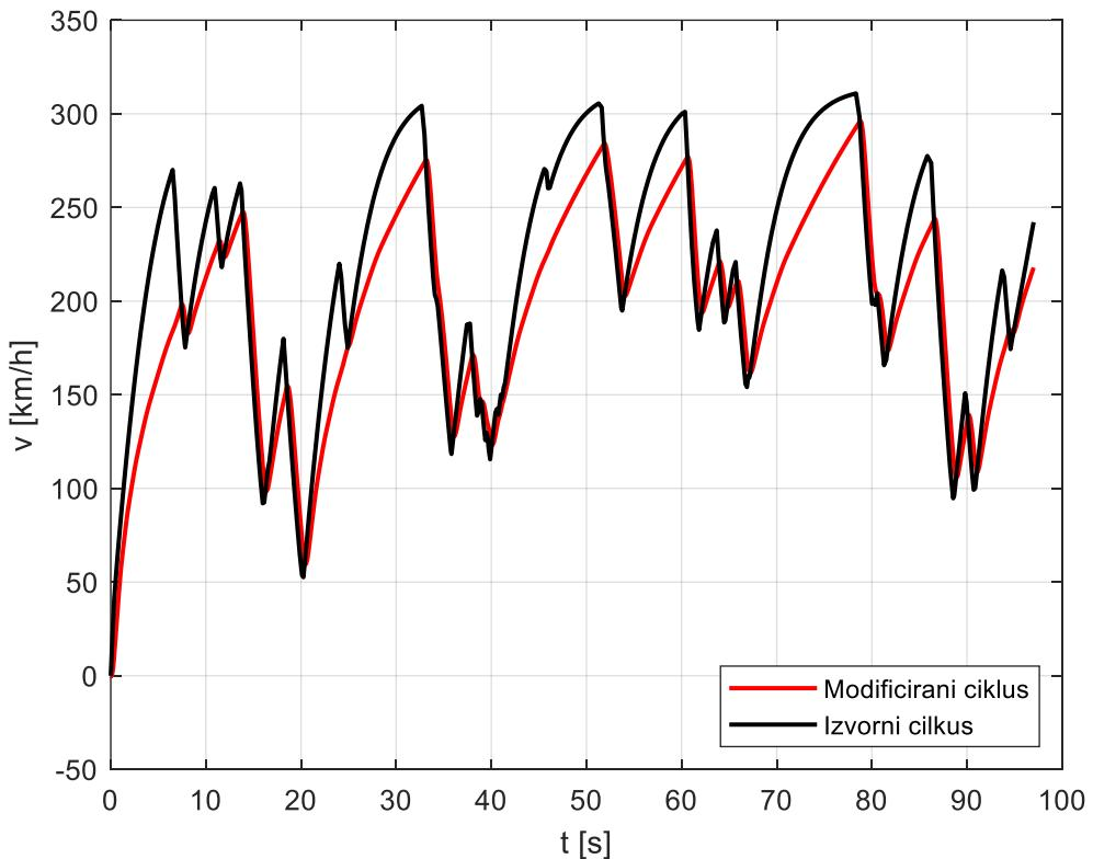
Slika 17. Usporedba izvornog i modificiranog voznog ciklusa.
