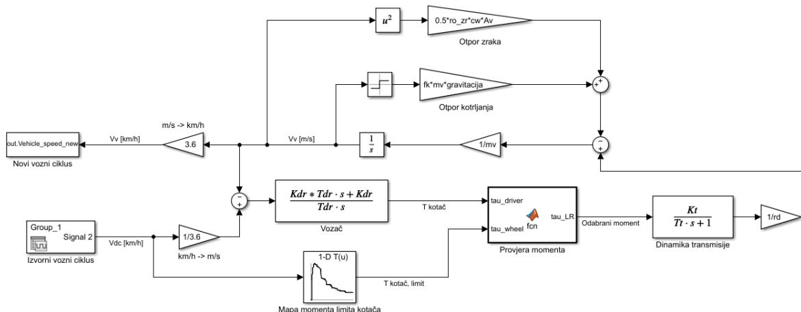
Slika 42. Unaprijedni model vozila.
