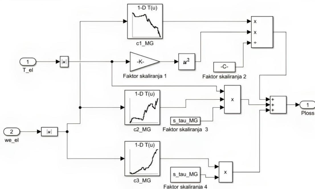
Slika 47. Simulink model mape korisnosti električnog motora.
