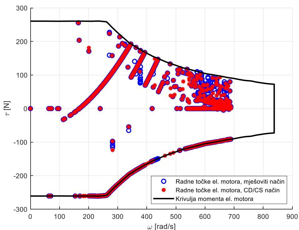
Slika 37. Usporedba radnih točaka električnog motora.
