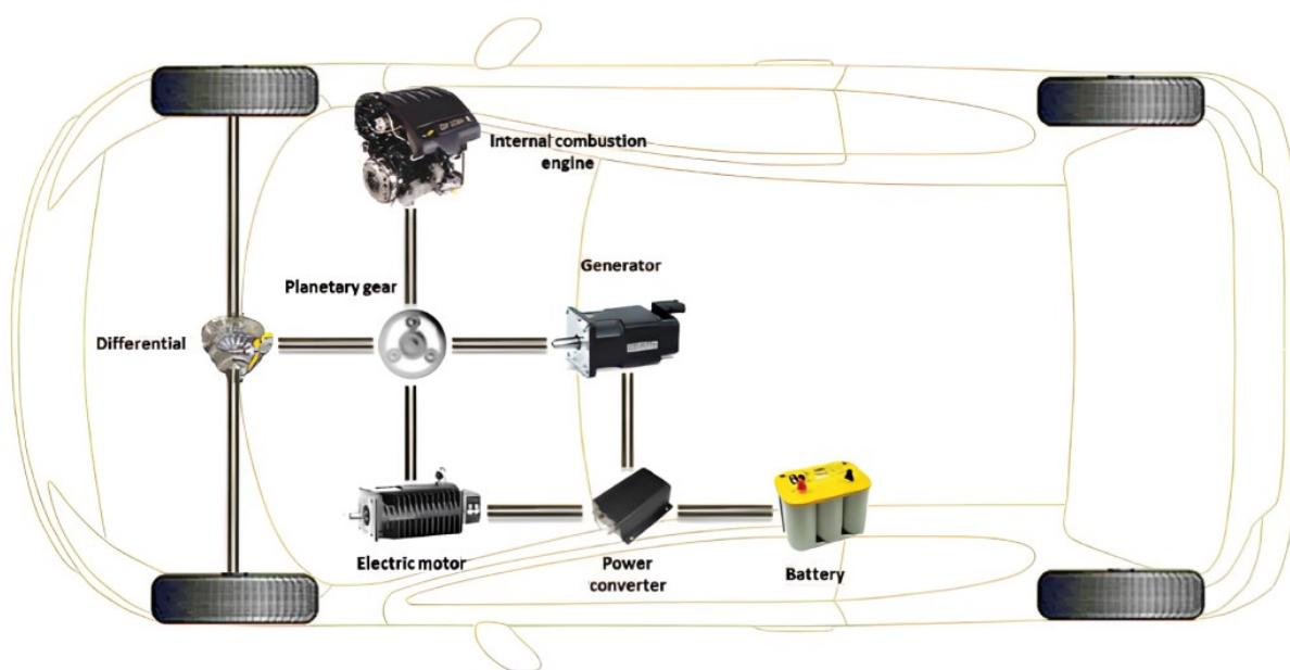
*Slika 5. Serijsko-paralelni konfiguracija hibridnog pogona (preuzeto iz [1]).*
