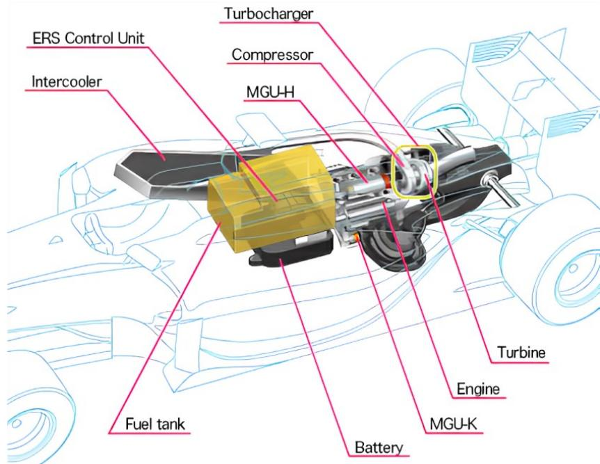
*Slika 8. Komponente pogonske jedinice Formule 1 2014 (preuzeto iz [9]).*
