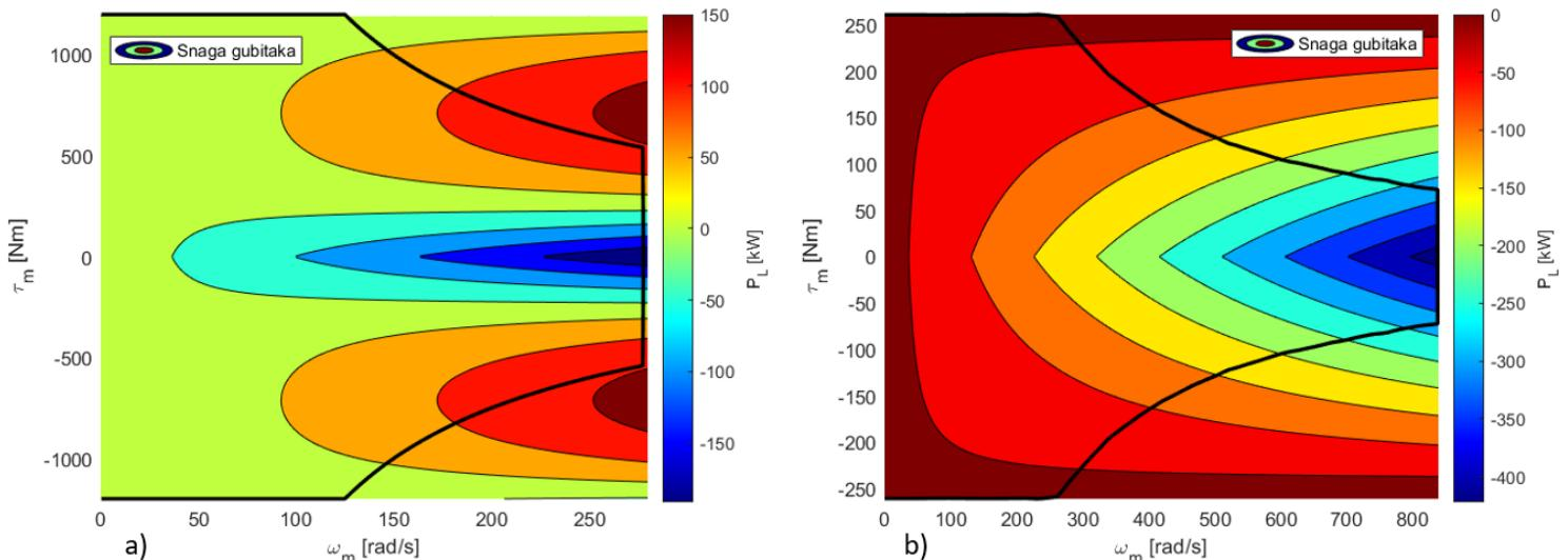
Slika 28. Mapa snage gubitaka električnog motora: a) izvorna, b)modificirana
