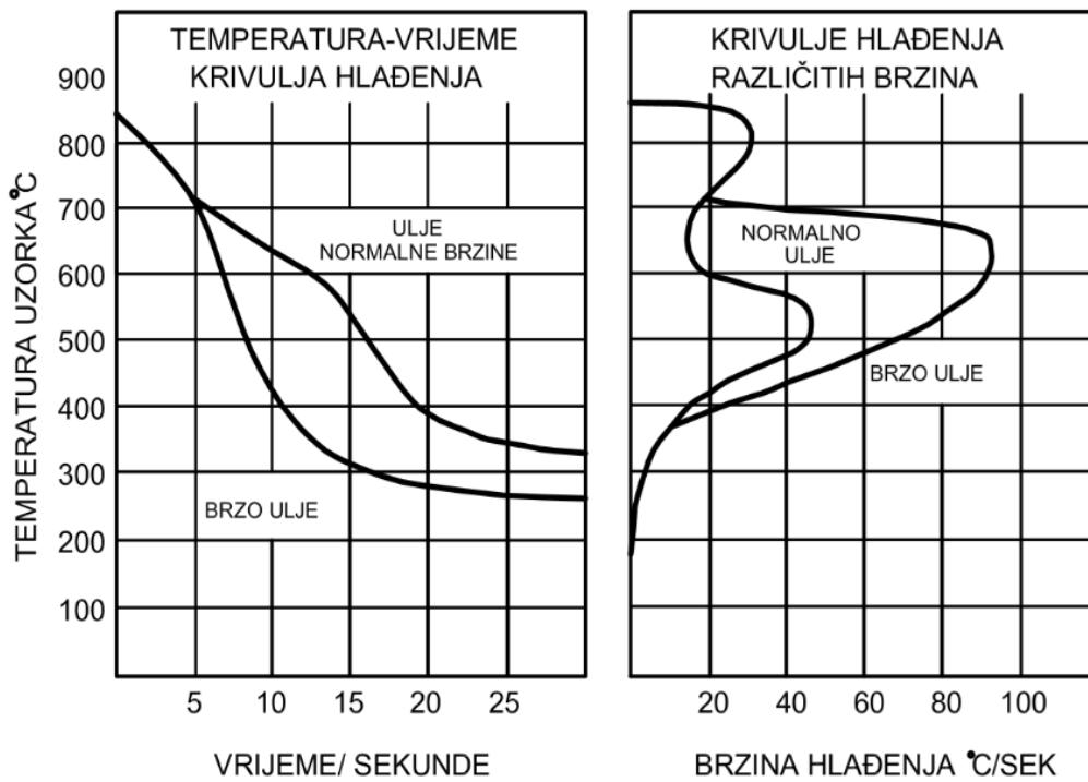
**Slika 7.Usporedba brzog i normalnog ulja za gašenje[6]**
