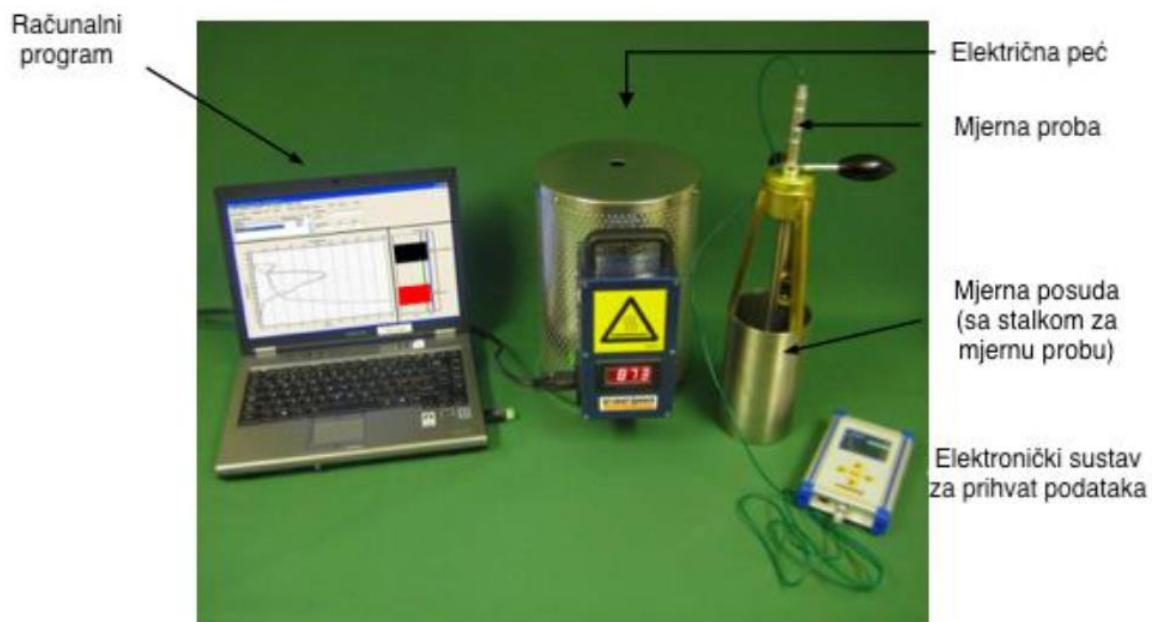
**Slika 13. Mjerni sustav IVF Smart Quench za ispitivanje[17]**
