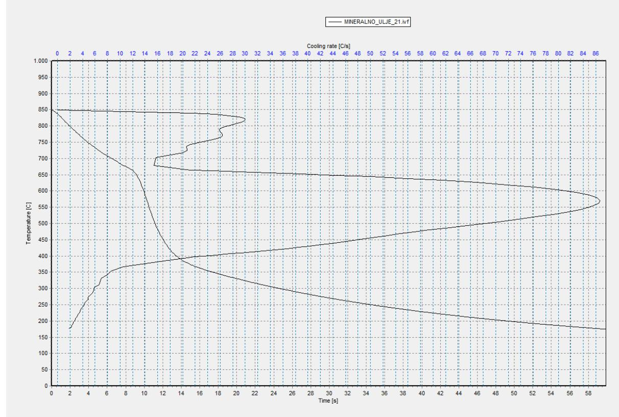
**Slika 16.Krivilja ohlađivanja (temperatura-vrijeme) i krivilja brzine ohlađivanja(brzina ohlađivanja-temperatura) ispitnog uzorka sredstva za kaljenje oznake MINERALNO\_ULJE \_21**
