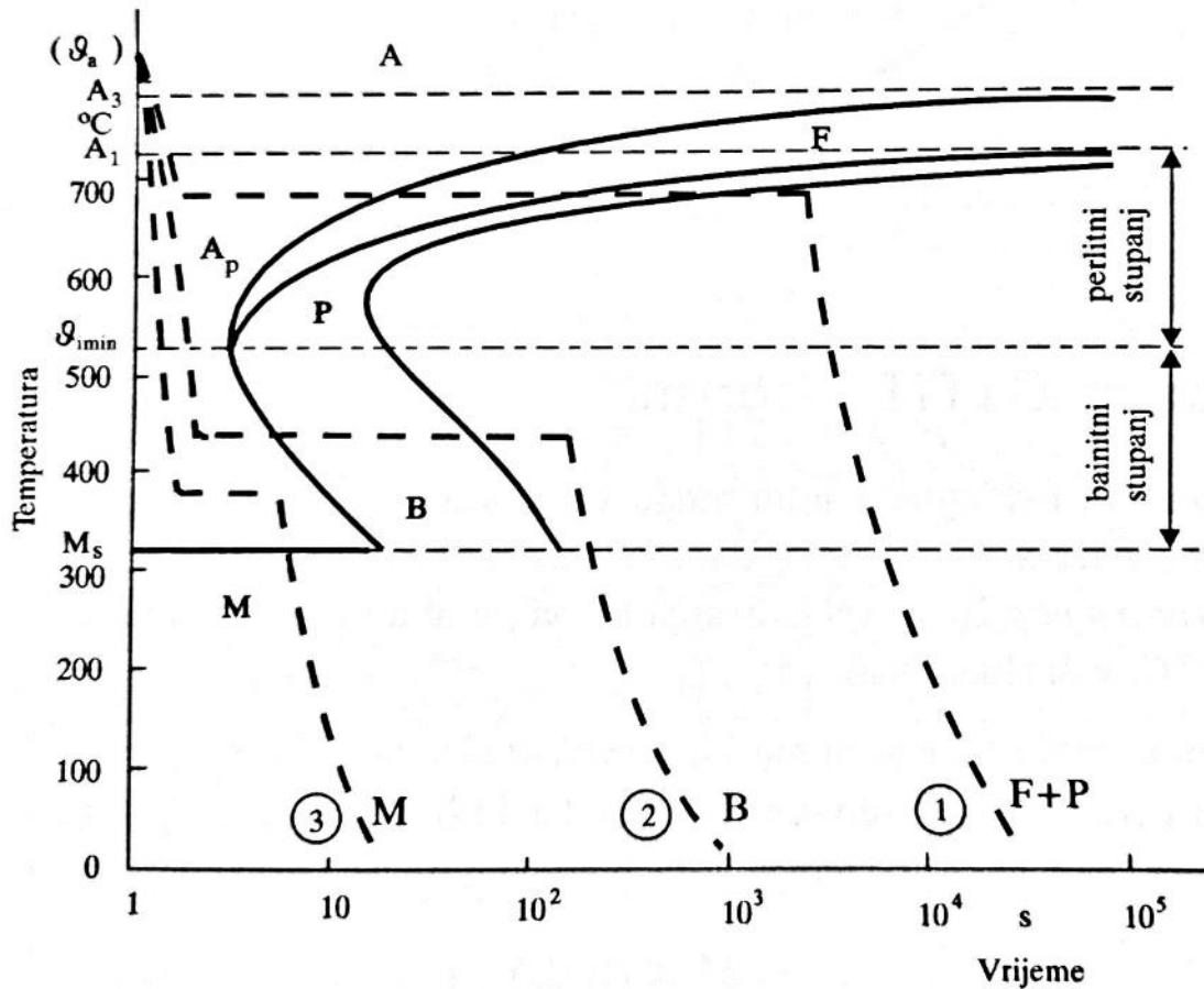
Slika 3. Izotermički TTT dijagram podeutektoidnog ugljičnog čelika [2]
