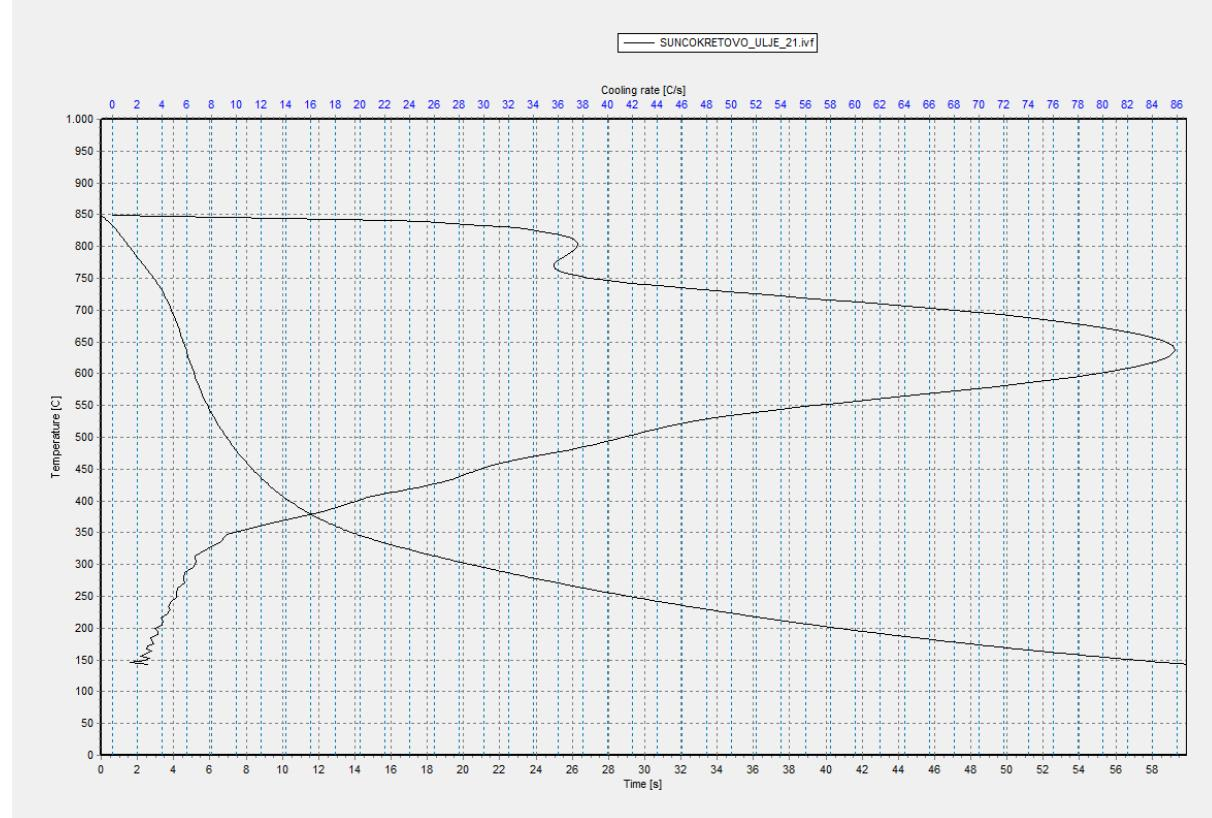
**Slika 19. Krivulja ohlađivanja (temperatura-vrijeme) i krivulja brzine ohlađivanja(brzina ohlađivanja-temperatura) ispitnog uzorka sredstva za kaljenje oznake SUNOKRETOVO \_ULJE \_21**
