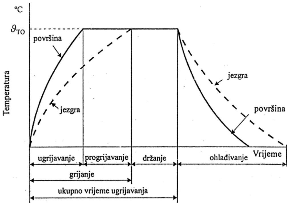
Slika 1. Prikaz postupka toplinske obrade materijala [1]
