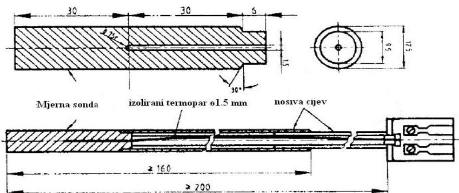
**Slika 14. Shematski prikaz mjerne probe za ispitivanje krivulja**
