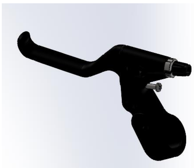
Slika 55. Ručica gasa sa tipkom za izbacivanje iz rada
