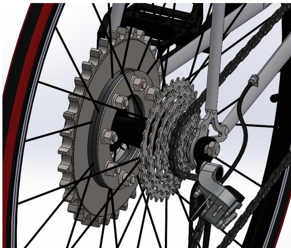
Slika 44. Rastavljeni sklop prihvata lančanika
