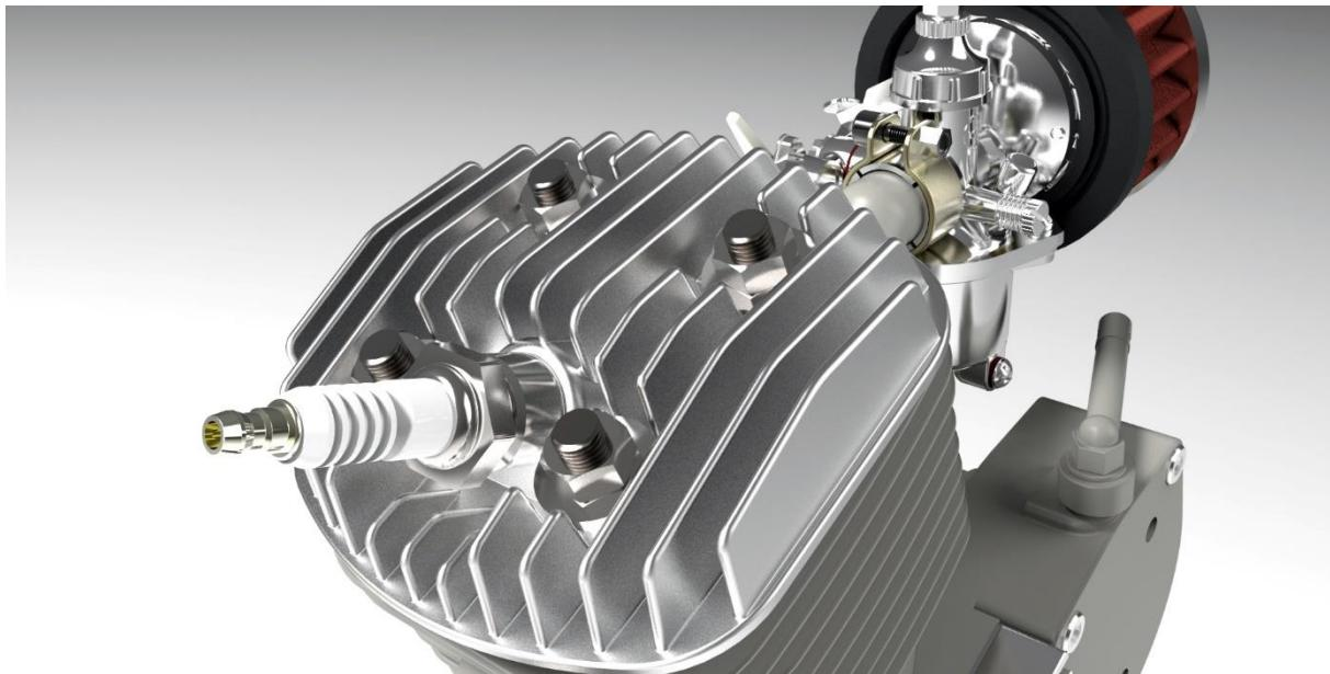
**Slika 27. Svjećica, zrakom hlađeno kućište i karburator**
