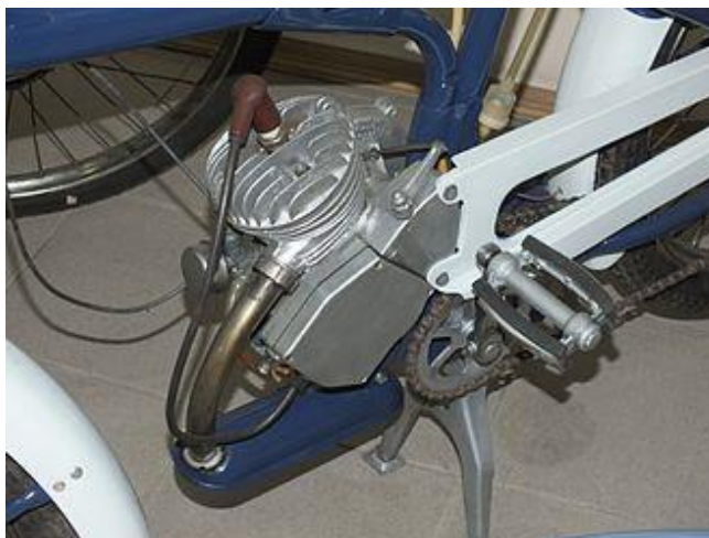
Slika 25. Izvorni "D-6" nadograđen na bicikl [1]
