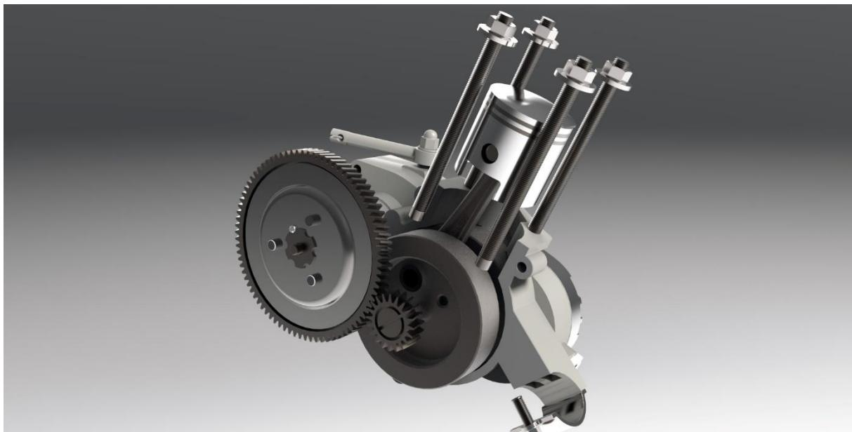
**Slika 26. Redukcijski stupanj i klipni mehanizam**
