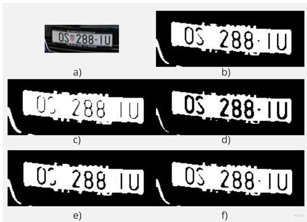
Slika 46. Koraci u predobradi registrarske pločice: a) originalna slika 103×39 piksela, b) povećana, zamučena i binarizirana slika u sivim nijansama, c) dilatacija, d) erozija, e) zatvaranje, odnosno dilatacija pa erozija, f) otvaranje, odnosno erozija pa dilatacija
