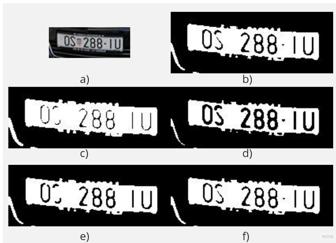
Slika 46. Koraci u predobradi registrarske pločice: a) originalna slika 103×39 piksela, b) povećana, zamućena i binarizirana slika u sivim nijansama, c) dilatacija, d) erozija, e) zatvaranje, odnosno dilatacija pa erozija, f) otvaranje, odnosno erozija pa dilatacija
