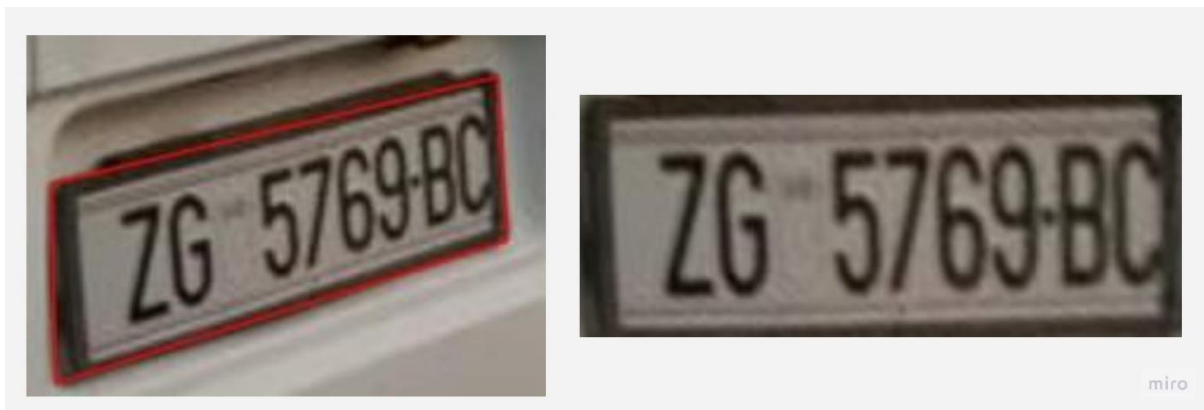
Slika 47. Transformacija na temelju četiri točke (engl. four point transform )
