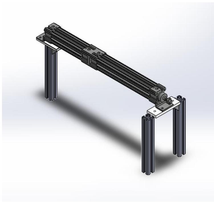
**Slika 3.18 Spoj pneumatskog cilindra i potporne konstrukcije**
