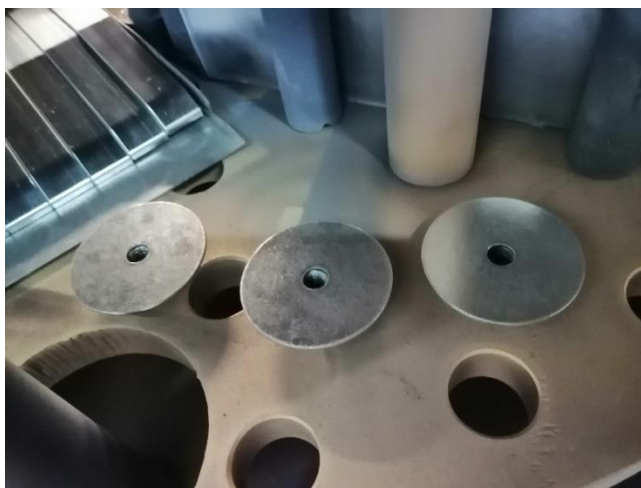
Slika 32. Uzorci nakon plazma nitriranja
