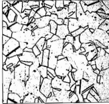
Slika 3. Mikrostruktura austenitnog čelika (100:1) [3]
