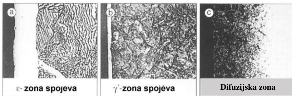
Slika 11. Mikrostruktura plazma nitriranih slojeva [9]
