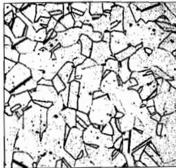
Slika 3. Mikrostruktura austenitnog čelika (100:1) [3]
