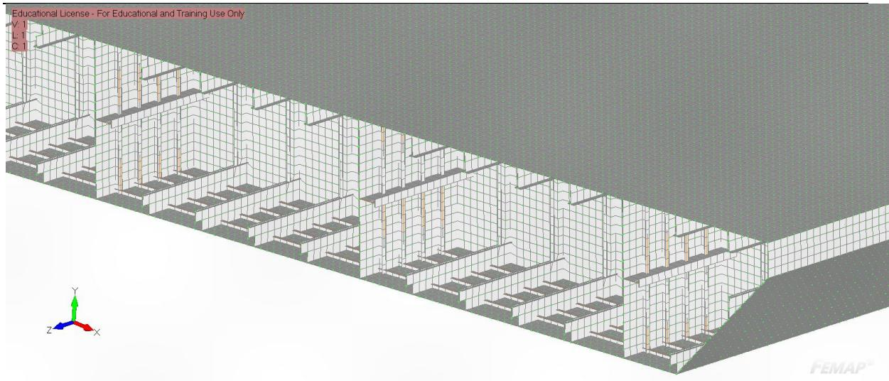
**Slika 15.** Prikaz izgleda konačnih elemenata jednog dijela geometrije
