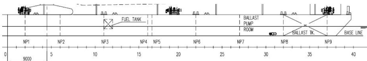
**Slika 5.** Prikaz raspodjele barže na 40 građevnih rebara
