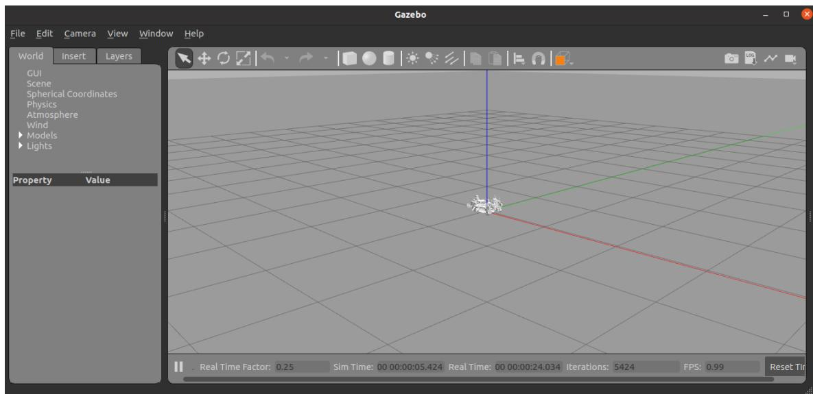
**Slika 19. Gazebo simulator s učitanim modelom robota**
