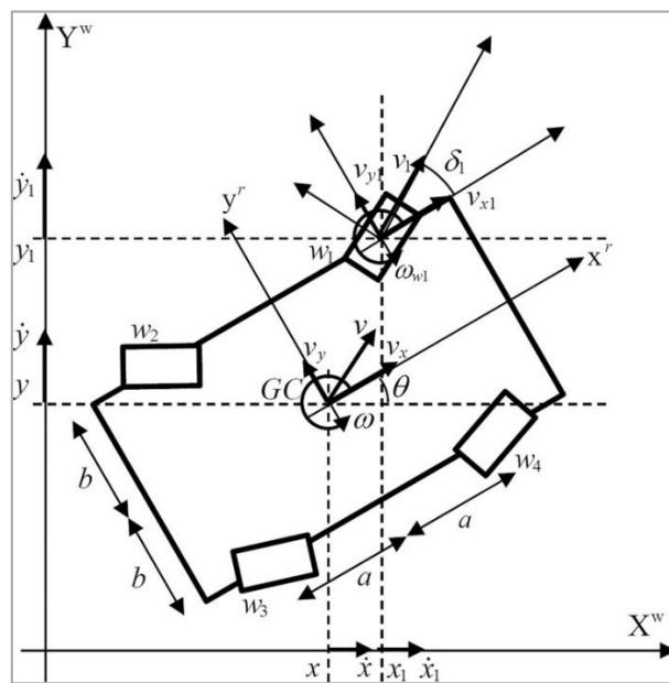
**Slika 3. Konfiguracija sustava robota u globalnom koordinatnom sustavu [2]**
