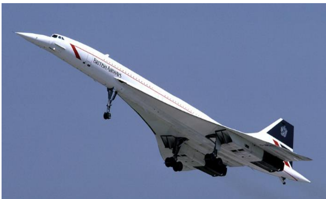
Slika 2. Nadzvučni putnički avion Concorde sa aluminijskom oplatom [3]
