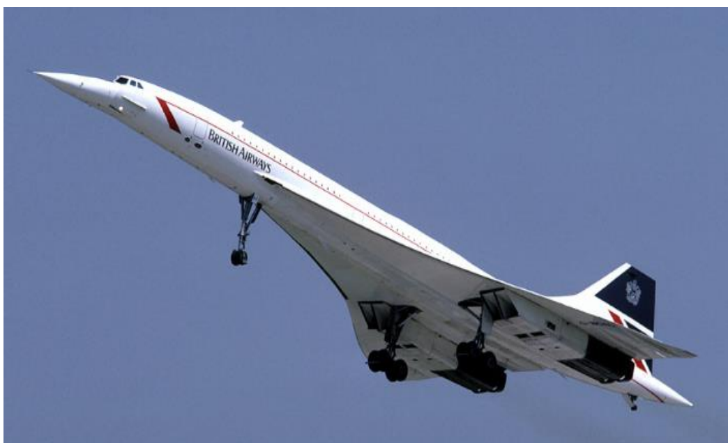
Slika 2. Nadzvučni putnički avion Concorde sa aluminijskom oplatom [3]
