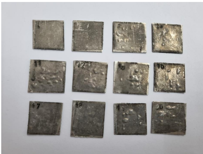
Slika 26. Uzorci nakon rastvornog žarenja i gašenja u vodi
