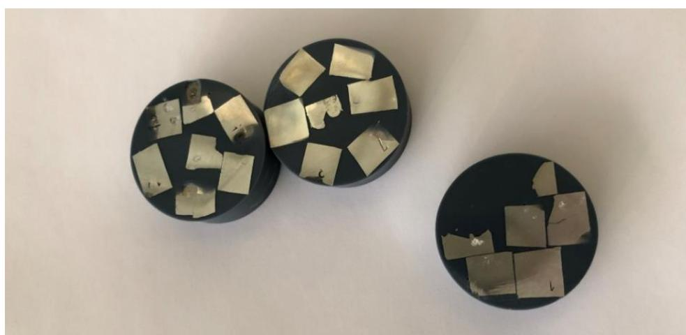
Slika 27. Uzorci spremni za mjerjenje tvrdoće
