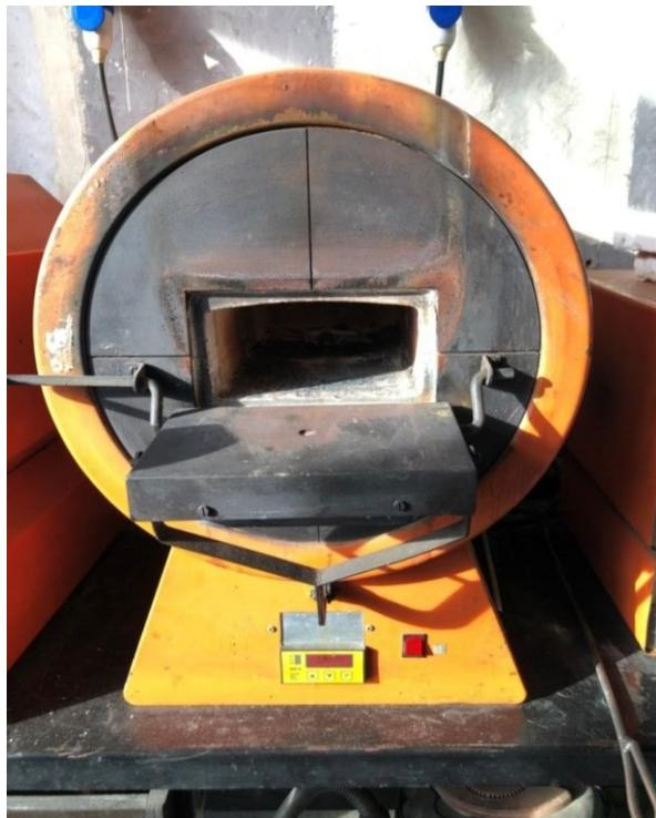
Slika 25. Laboratorijska elektrootporna peć
