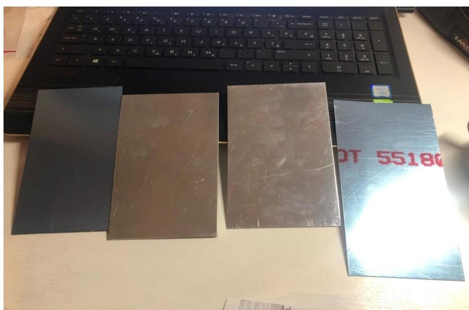
Slika 20. Uzorci aluminijeve legure u polaznom stanju
