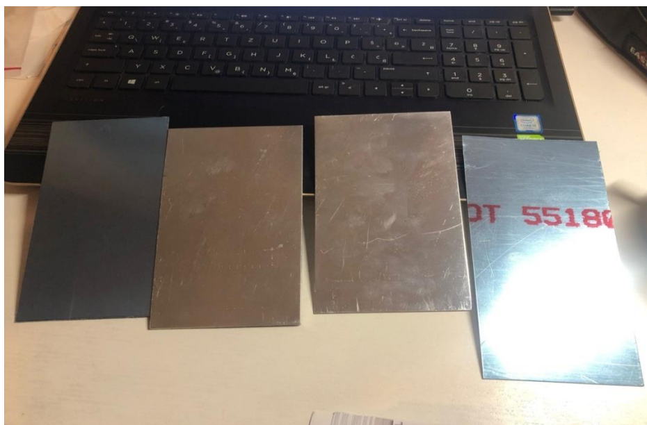
Slika 20. Uzorci aluminijske legure u polaznom stanju
