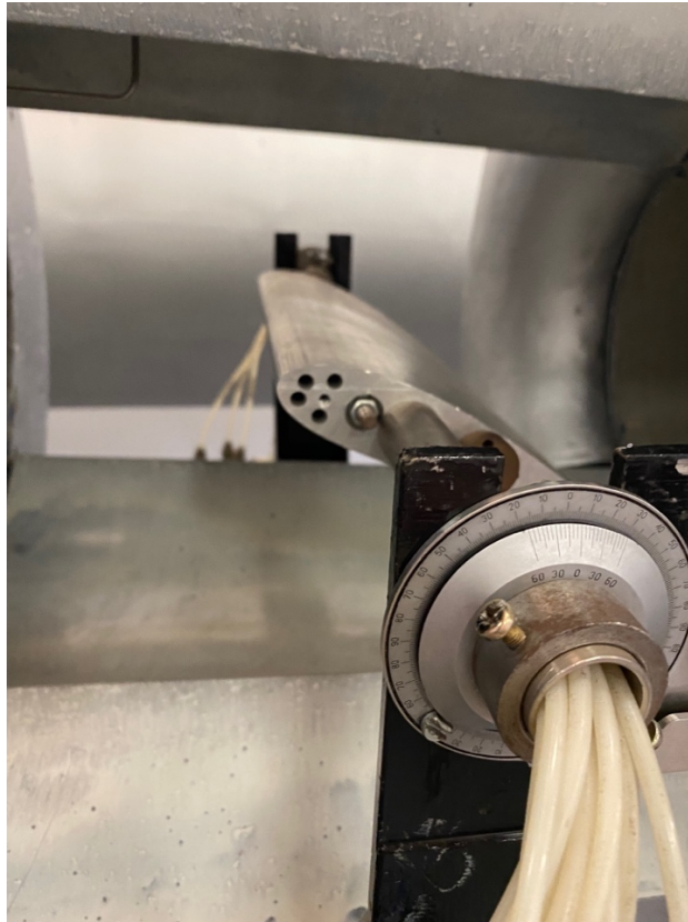
Slika 4-1 Radna sekcija sa već postojećim aeroprofilom
