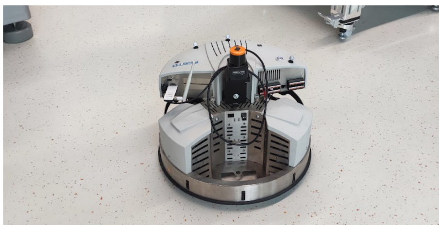
Slika 2.6: Hokuyo senzor montiran na Robotino-a
