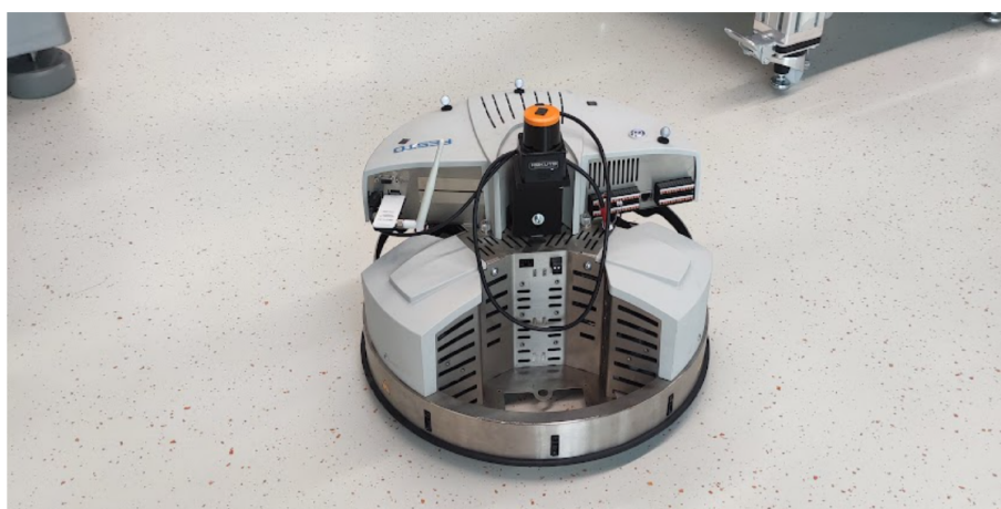
Slika 2.6: Hokuyo senzor montiran na Robotino-a
