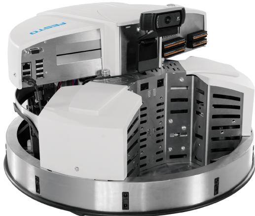
Slika 2.1: Robotska platforma Robotino 3
