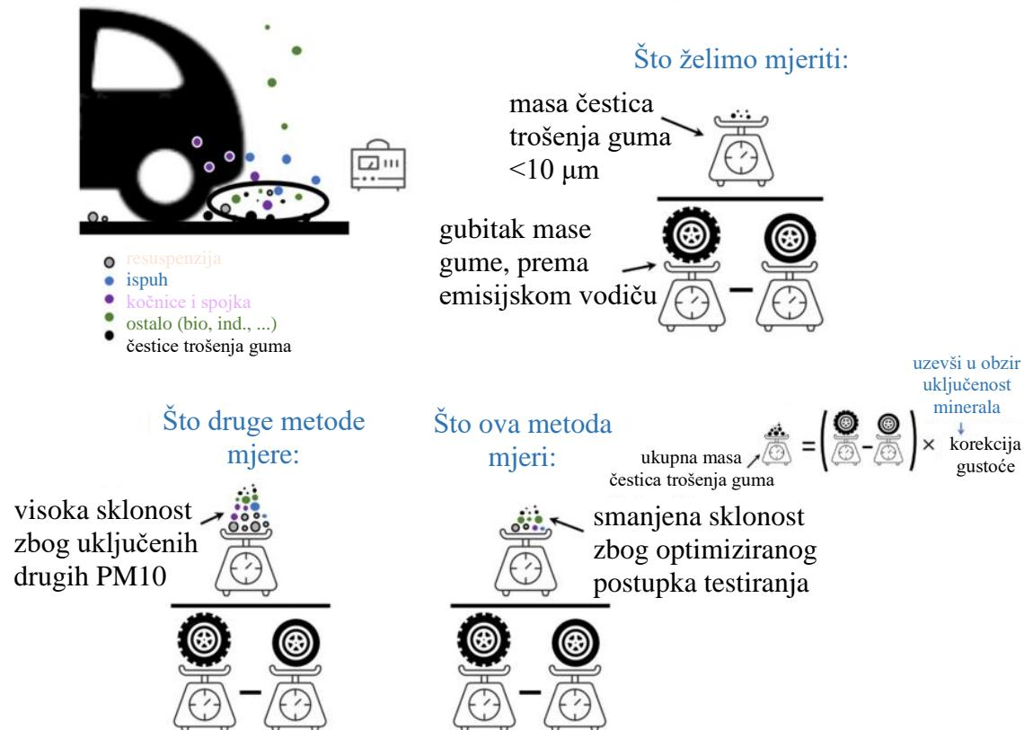
Slika 17. Tehnički zahtjevi za mjerjenje emisija PM čestica trošenja guma [11]
