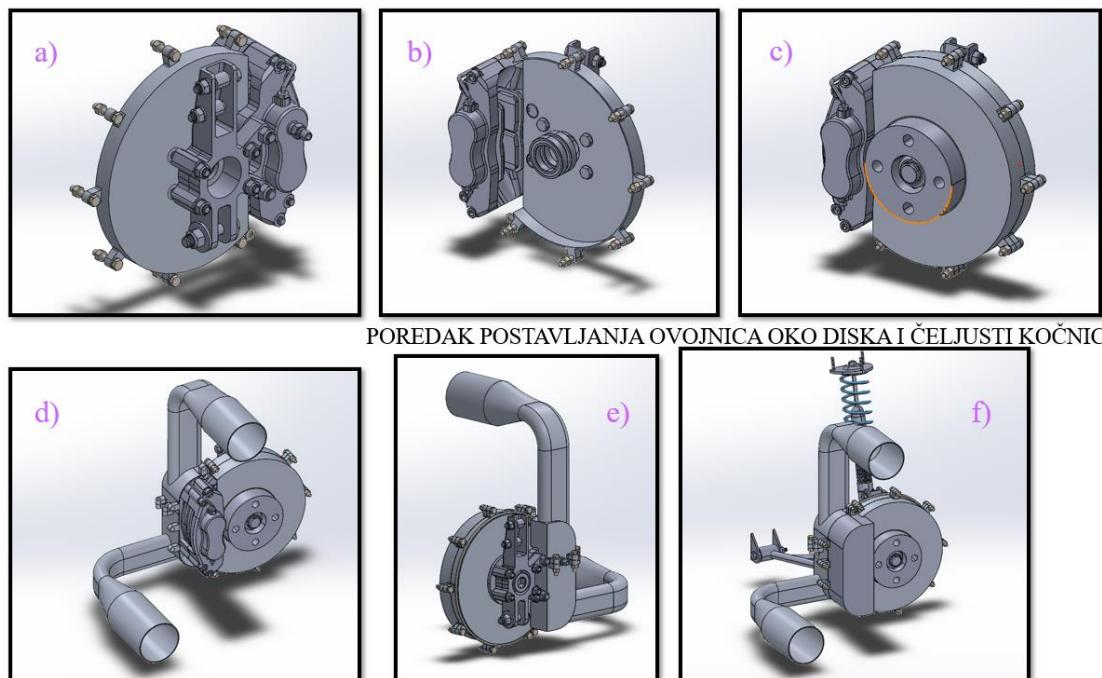
**Slika 23. Poredak postavljanja ovojnica oko diska i čeljusti kočnice**
