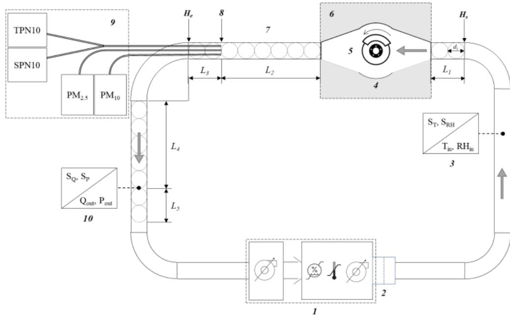
**Slika 9. Mjerni postav s dinamometrom za provođenje testa emisija pri kočenju u laboratoriju [6]**
