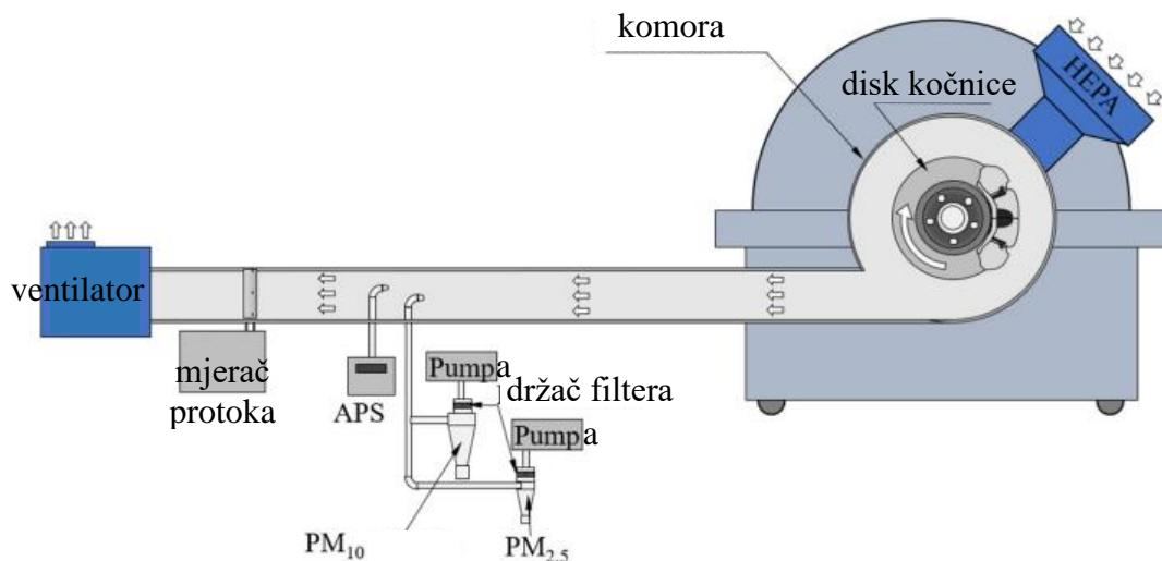
**Slika 7. Shema testnog postava za mjerenje čestica nastalih trošenjem kočnica pomoću dinamometra [4]**
