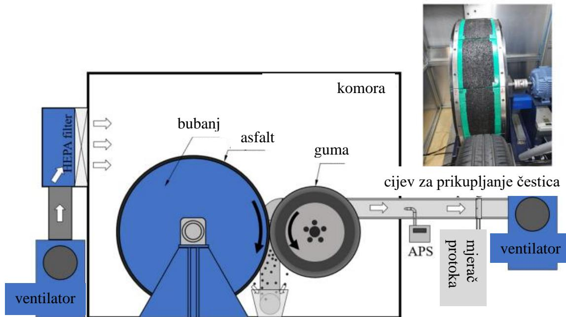
**Slika 11. Shema testnog postava za ispitivanje i mjerjenje karakteristika čestica trošenja guma [4]**
