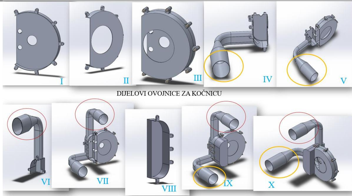
Slika 21. Dijelovi ovojnica za kočnicu i sklapanje tih dijelova
