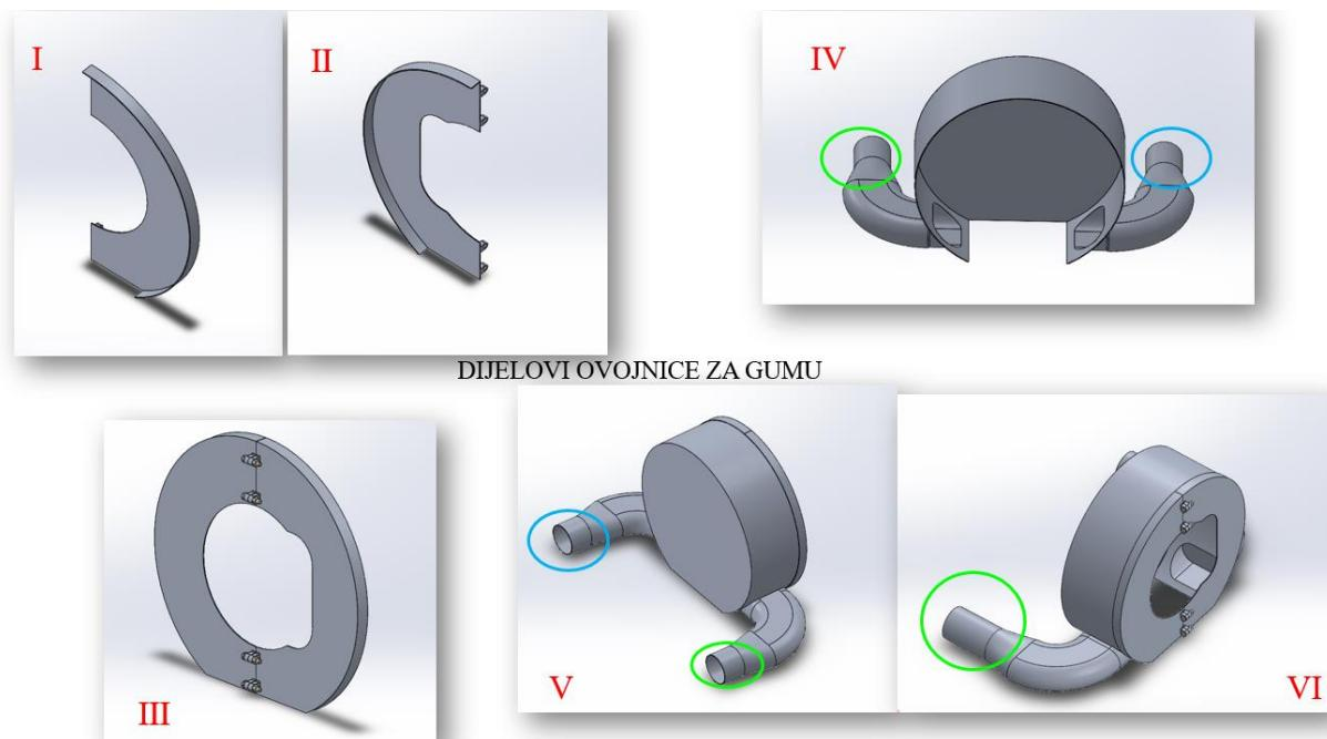
Slika 22. Dijelovi ovojnica za gumu i njihov sklop
