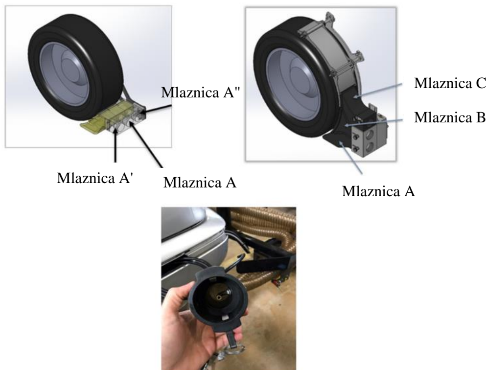
Slika 18. Dvije verzije mlaznica koje se koriste za prikupljanje čestica trošenja gume i mjerenje emisije PM čestica [10]
