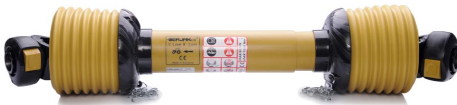
Slika 3. Kardansko vratilo od traktora
