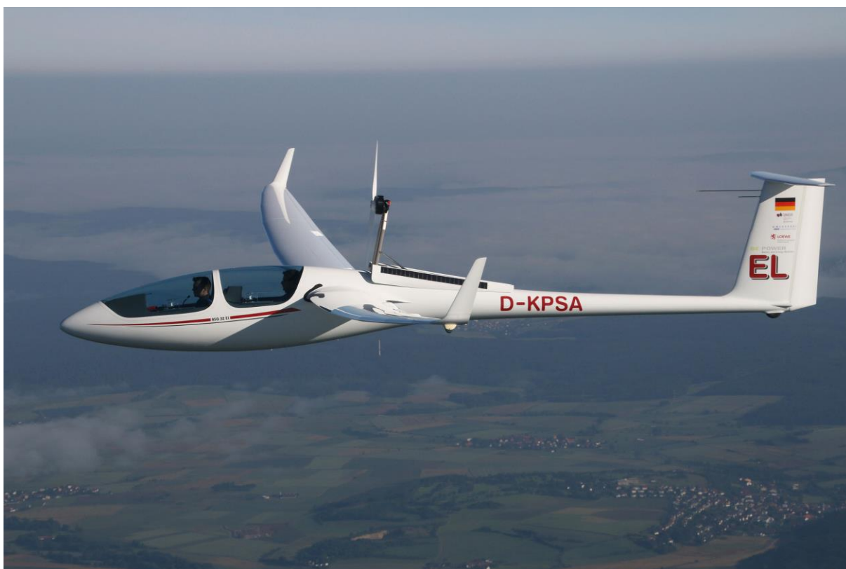
Slika 1. Jedrilica s električnim pogonom u letu [1]
