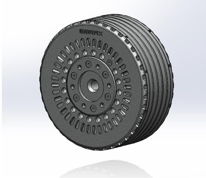
Slika 11. Izometrijski prikaz modela električnog motora
