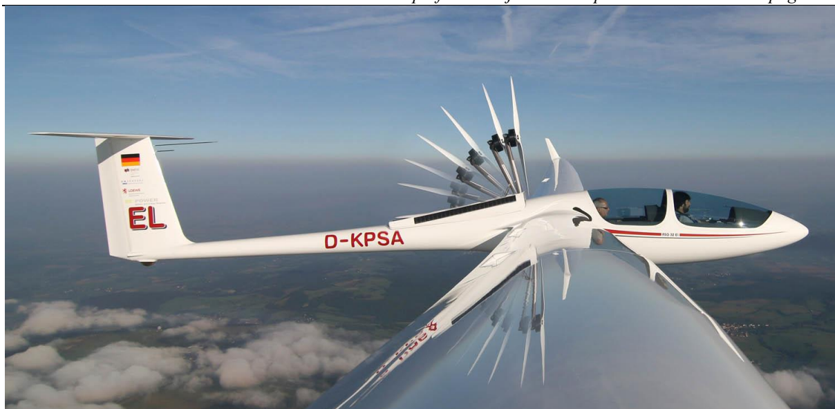
Slika 23. Prikaz izvlačenja pogonske jedinice iz trupa [1]
