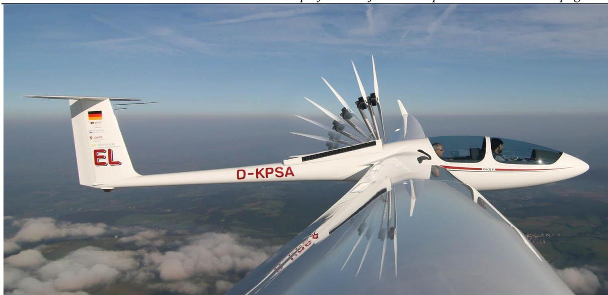
Slika 23. Prikaz izvlačenja pogonske jedinice iz trupa [1]
