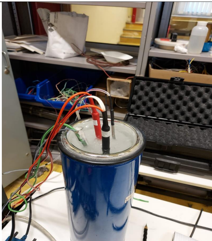
Slika 15. Hladni krajevi termoparova pri temperaturi od 0 °C
