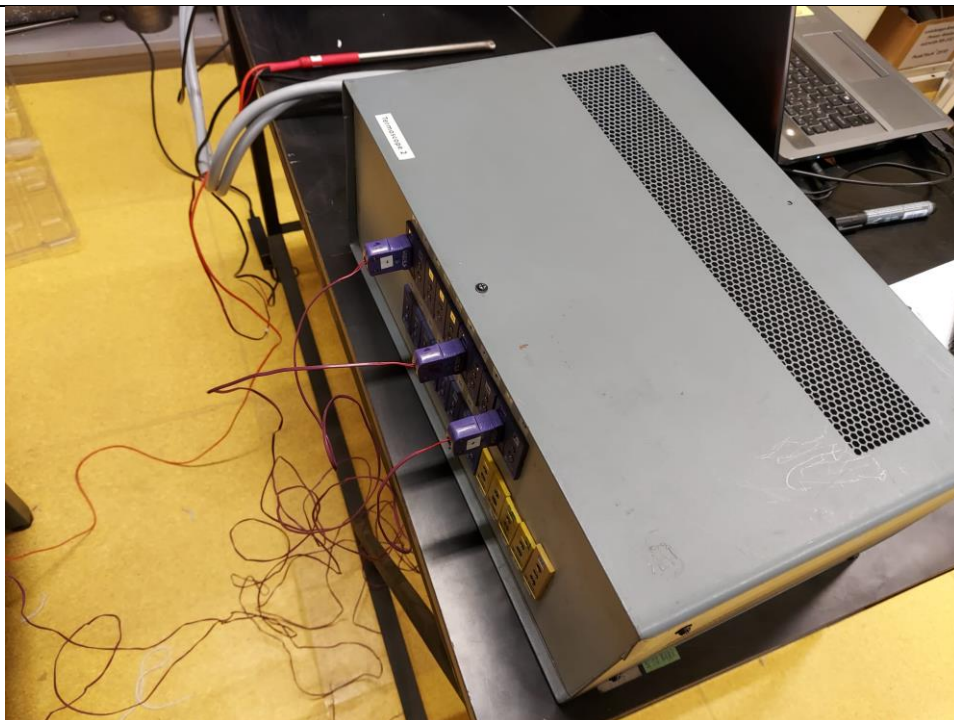
Slika 11. Multipleksor na koji su spojene dvije termoparske žice
