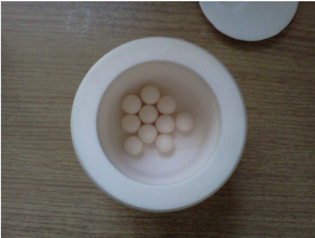
Slika 3.3. Posuda za miješanje s deset keramičkih kuglica.
