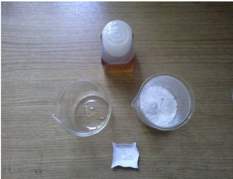
Slika 3.2. Komponente suspenzije: Darvan, spinel, Al_2O_3 prah.
