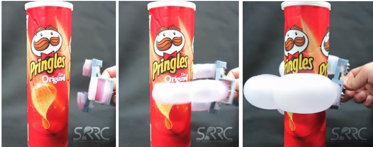
Slika 52. Princip hvatanja Miura hvataljkom [21]
